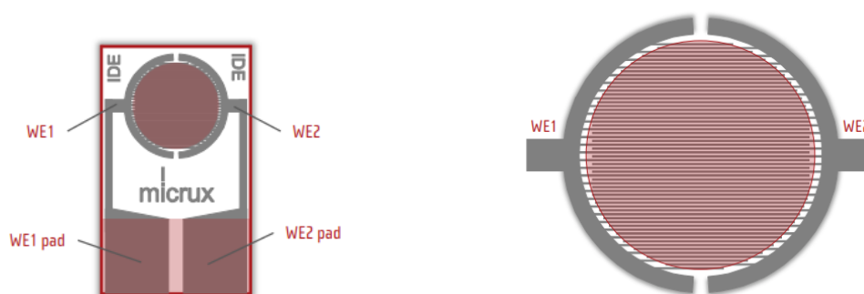
Figura 5. IDE (identificación de cada electrodo (izda) y ampliación de la zona de la gota (dcha))
