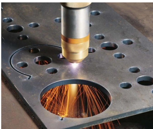
Fig. 90 Corte por Plasma
