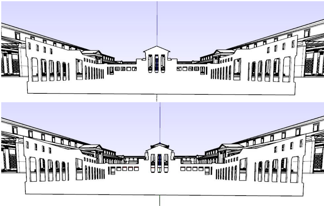
Fig. 62-63 Modelo 3D de la señal con dimensiones modificadas. Arriba, punto de vista de una persona en silla de ruedas Abajo, punto de vista de una persona de pie
