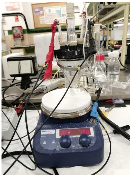
Figura 30 Esquema de trabajo para llevar a cabo cronoamperometría incluyendo el sistema de agitación.
