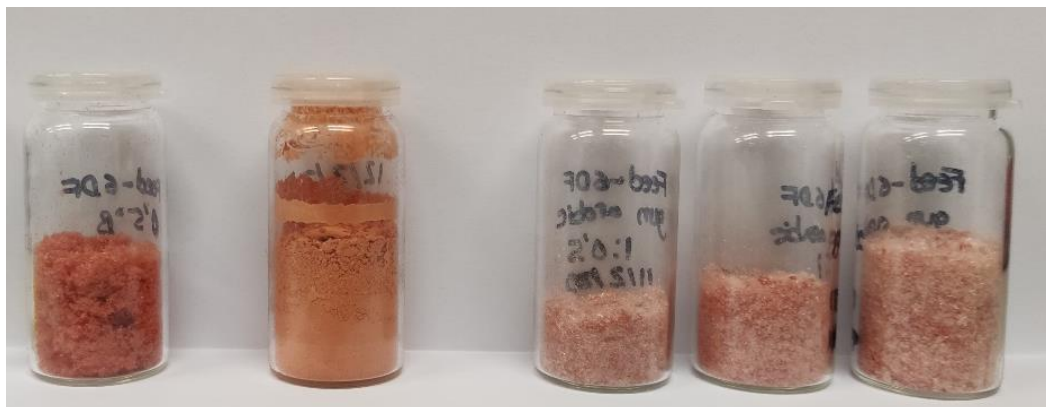
Figura 37 De izquierda a derecha: (vial 1) Pigmentos sin encapsular liofilizados, (vial 2) pigmento con encapsulante 1:1 secados en el secadero; (vial 3) pigmento con encapsulante 1:0,5 liofilizados; (vial 4) pigmento con encapsulante 1:1 liofilizados; (vial 5) pigmento con encapsulante 1:1,5 liofilizados. En la figura se puede ver esos pigmentos en detalle.
