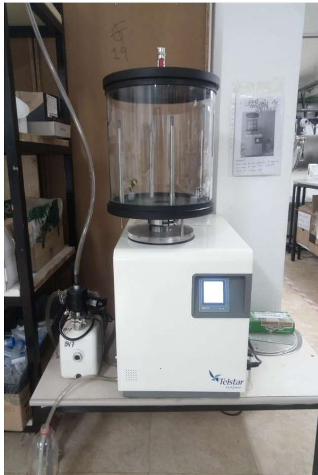
Figura 15 Liofilizador usado para liofilizar los productos obtenidos.
