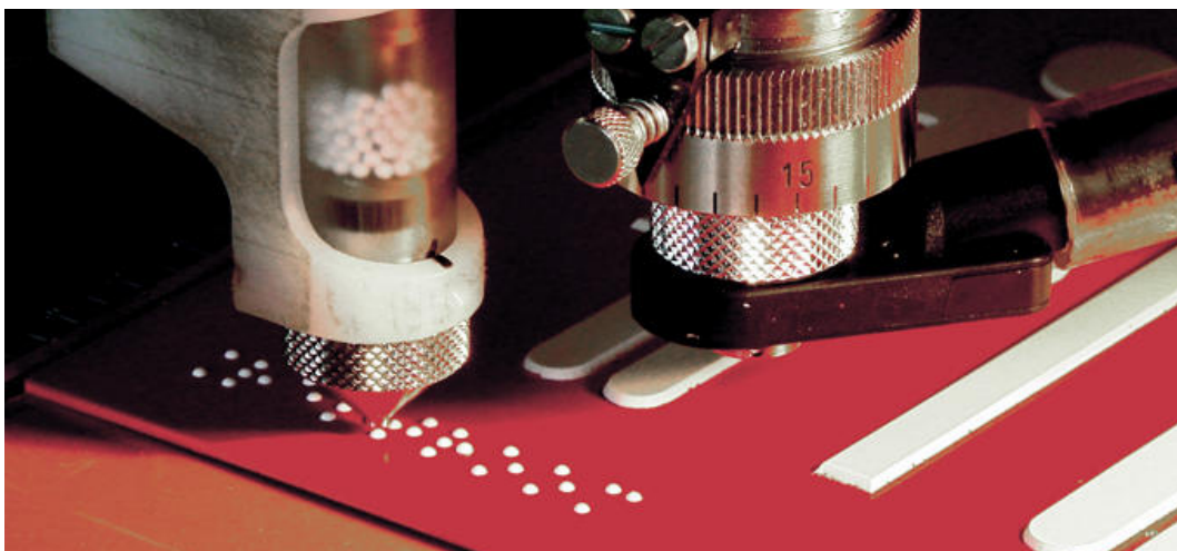
fig. 121: técnica de marcaje braille automatizado
