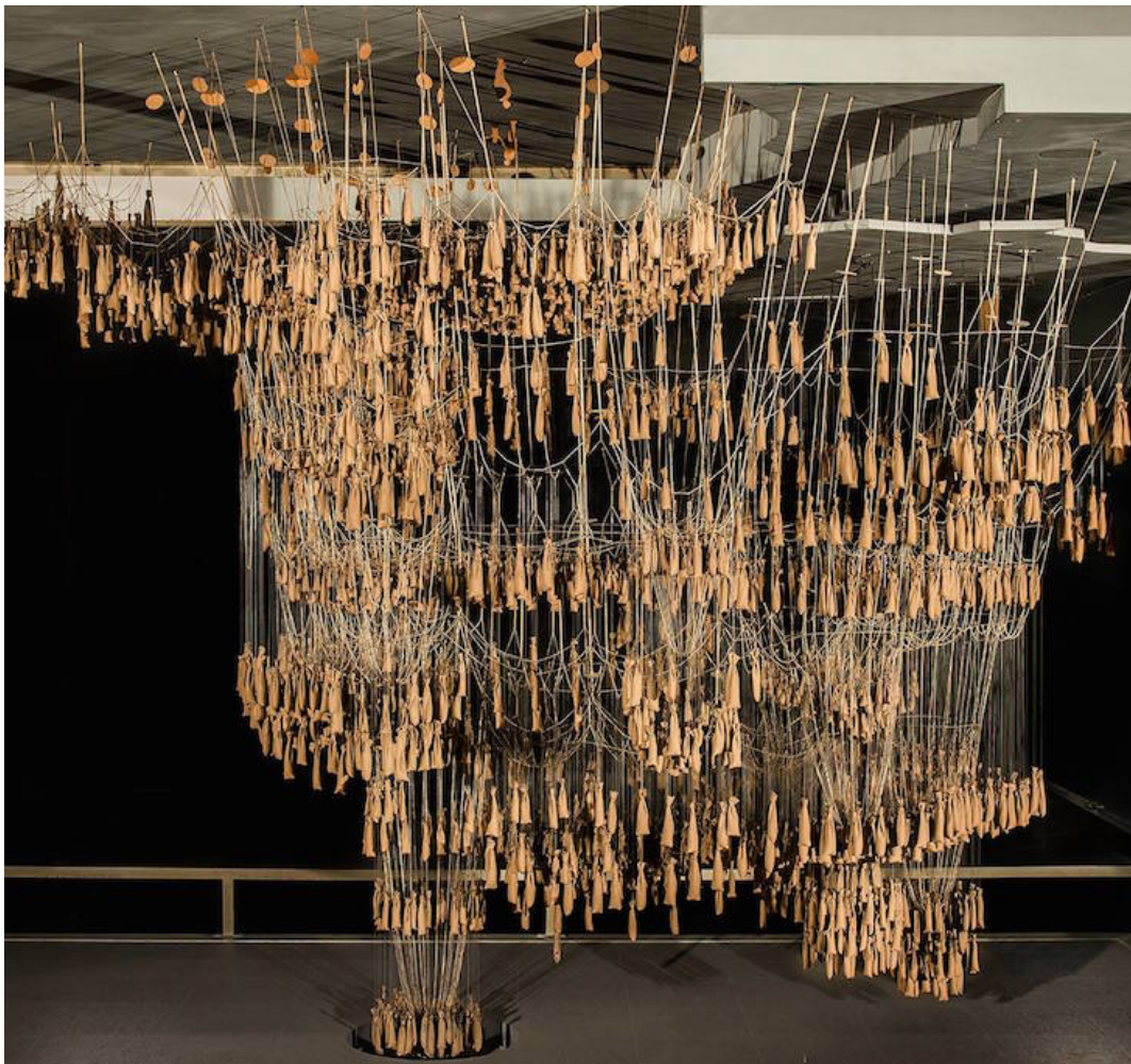
fig. 99: Maqueta de la Sagrada Família de Gaudí, hecha a base de catenarias colgando del techo.
