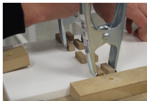
fig. 122: operario preparando las planchas para unir las.
