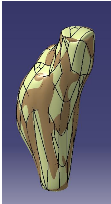
Figura 3.13 Superficie generada en Catia junto con la nube de puntos. Fuente propia.
