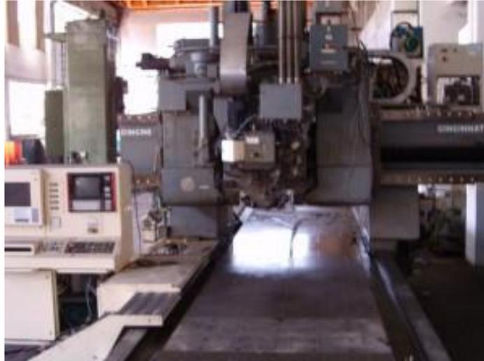
*Figura 3.9: Fresadora de pórtico. Fuente : Clasificación y tipos de fresadoras.*
