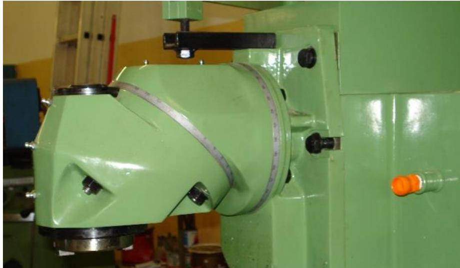
Figura 3.18: Cabezal vertical universal. Fuente: Wikipedia.
