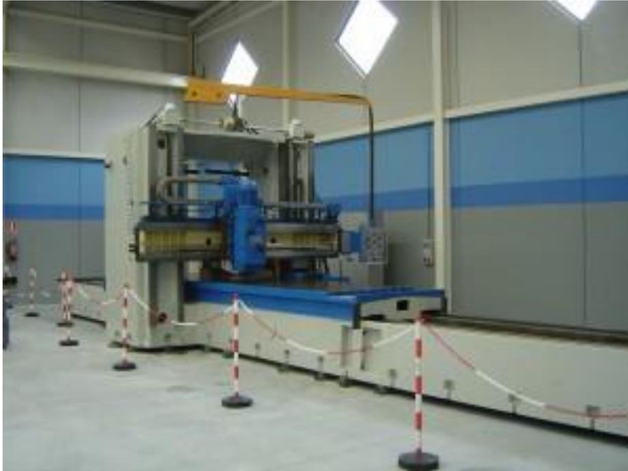
Figura 3.10: Fresadora de puente móvil. Fuente : Clasificación y tipos de fresadoras.
