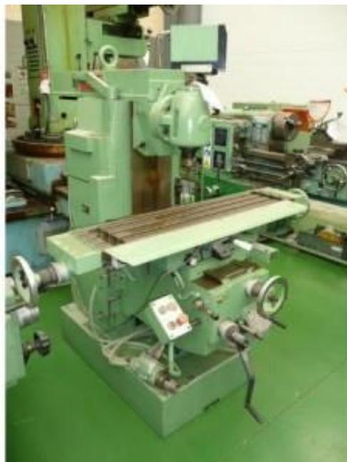
*Figura 3.6 : Fresadora universal. Fuente : Clasificación y tipos de fresadoras.*
