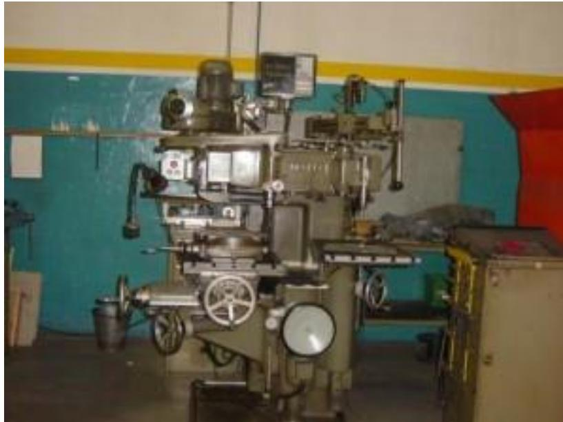
*Figura 3.8 : Fresadora copiadora. Fuente : Clasificación y tipos de fresadoras.*
