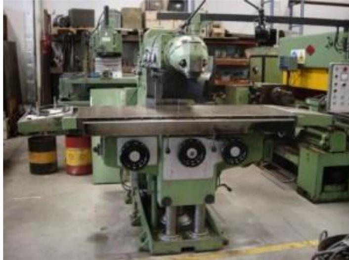
*Figura 3.4: Fresadora Vertical de banco fijo o bancada.
