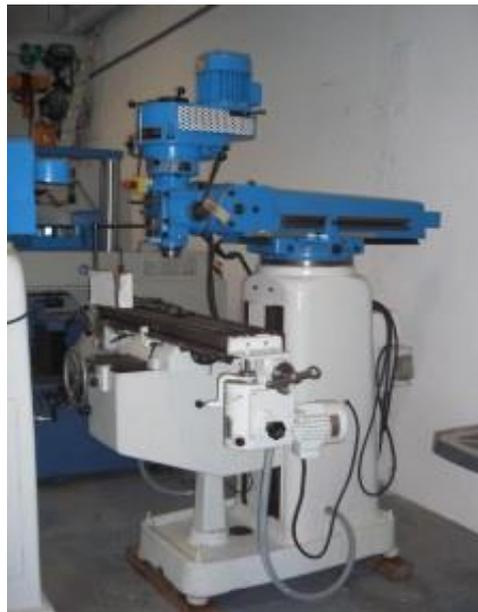
*Figura 3.5: Fresadora vertical de torreta o consola. Fuente : Clasificación y tipos de fresadoras.*
