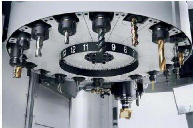
*Figura 3.17: Cambiador automático de herramientas – Tipo carrusel. Fuente : HAASCNC.*
