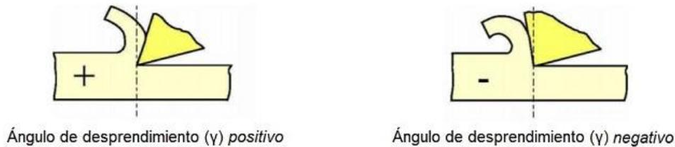
Figura 3.29: Tipos de ángulo de desprendimiento ( $\gamma$ ). Fuente : Fundamentos de los procesos de mecanizado.
