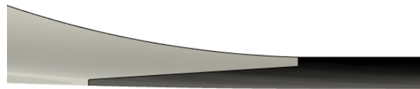
Ilustración 43 - Corte oblicuo sobre la parte inferior de la férula con el objetivo de obtener un cambio de rigidez gradual.
