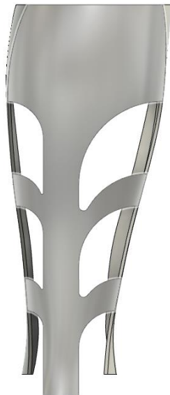
Ilustración 46 –Vista de alzado de la parte superior de la órtesis tras el corte en el plano frontal.
