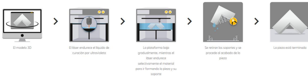
Ilustración 50 - Proceso de impresión mediante estereolitografía
