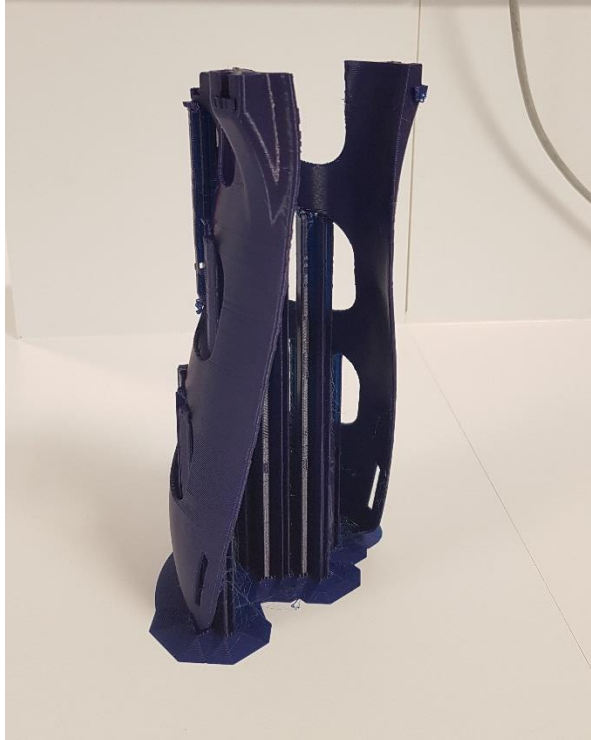
Ilustración 70 - Parte superior del DAFO en PLA antes de retirar los soportes.
