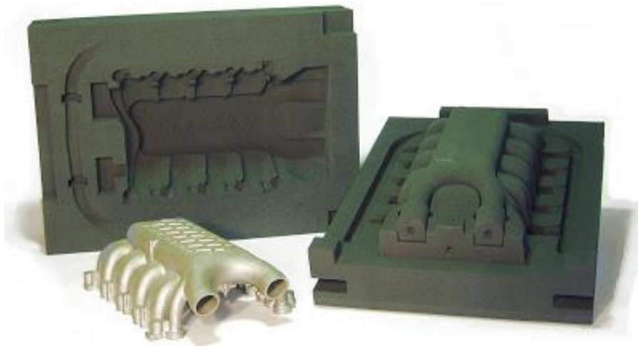
Ilustración 56 - Molde impreso mediante inyección de aglutinante en arena
