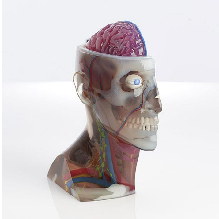
Ilustración 54 - Pieza impresa mediante Material Jetting
