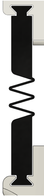
Ilustración 33 - Pieza encargada del retorno del pie a su posición de reposo.
