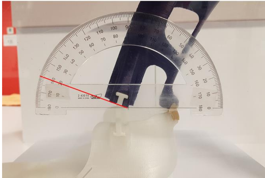
Ilustración 76 - Verificación del ángulo durante la plantarflexión.
