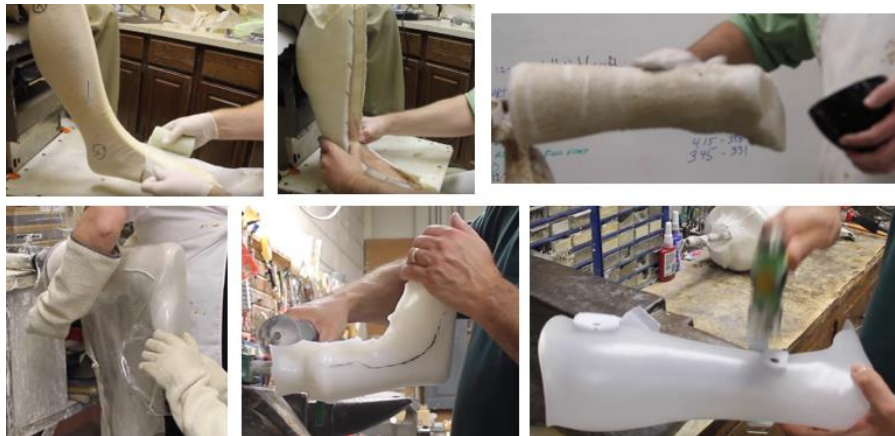
Ilustración 2 – Diferentes etapas del proceso de fabricación tradicional de un AFO.
