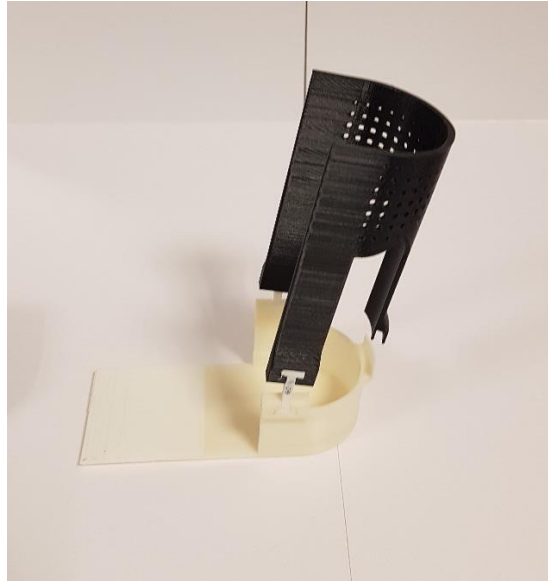
Ilustración 28 - Prueba concepto de DAFO cuya parte superior e inferior están separadas.
