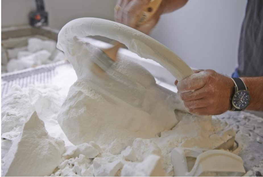
Ilustración 53 - Limpieza del polvo sobrante de una pieza impresa mediante SLS
