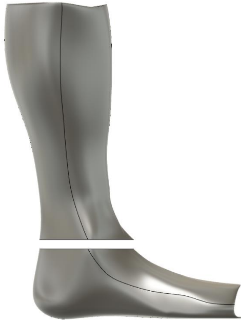
Ilustración 41 - División del sólido en dos partes que se corresponden con la parte superior e inferior de nuestro DAFO.
