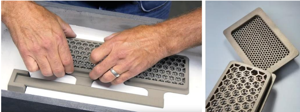
Ilustración 57 - Pieza impresa mediante inyección de aglutinante en metal antes y después de someterse al proceso de infiltración
