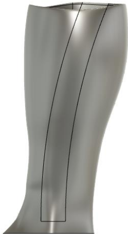
Ilustración 45 - Estructura lateral de la parte superior de la órtesis.
