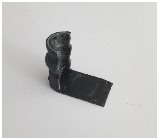
Ilustración 27 - Prueba concepto TPU y ABS.
