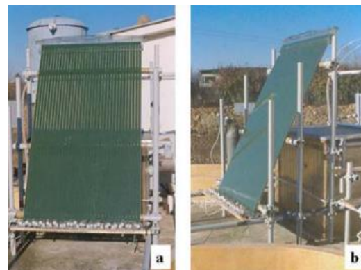
Figura 14. Diseño de biorreactor de paneles alveolares construido para investigar el crecimiento de Spirulina platensis en el exterior. a) Vista frontal; b) vista lateral (de Carlozzi, 2008).
