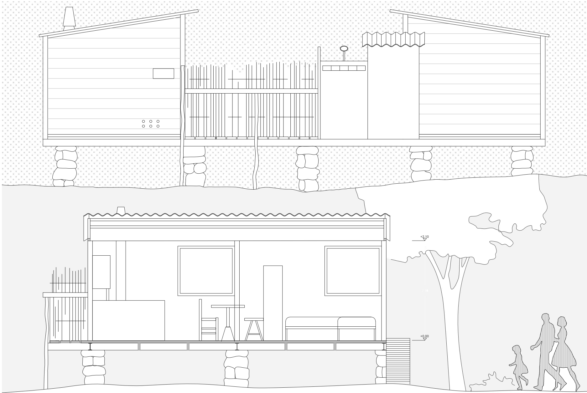
4.132_Alzado trasero y Sección longitudinal del volumen B redibujadas 1:50
