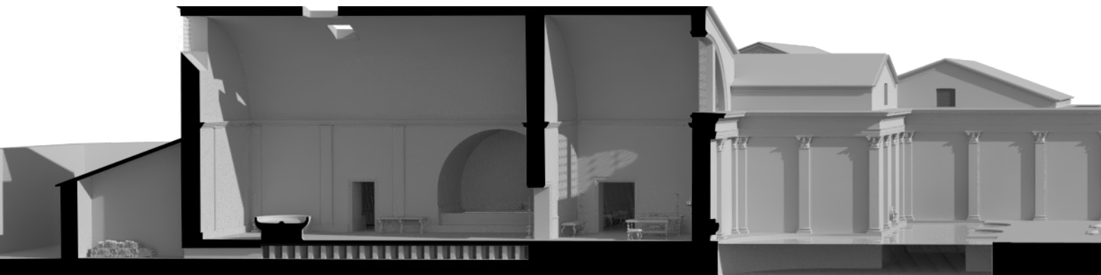
Fig. 55: reconstrucción de la sección longitudinal por el centro del edificio termal, sucesión de praefurnium - caldarium - destrictarium - natatio - jardín - exedra - entrada.
