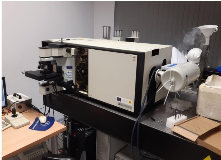
Figura 6 Espectrómetro Raman y microscopio utilizados en este trabajo.
