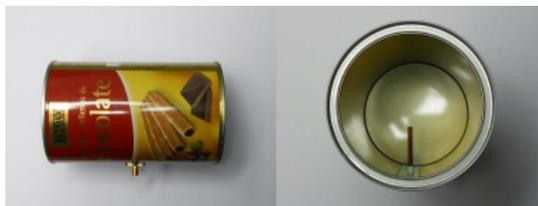
Figura 10.3: Antenas usadas en el montaje [XVI]
