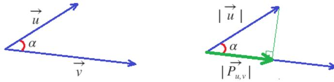
Figura 7.8: Producto escalar y proyección de un vector sobre otro [XI]
