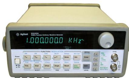
Figura 10.8: Generador de funciones *Agilent 33120A* [XIX]
