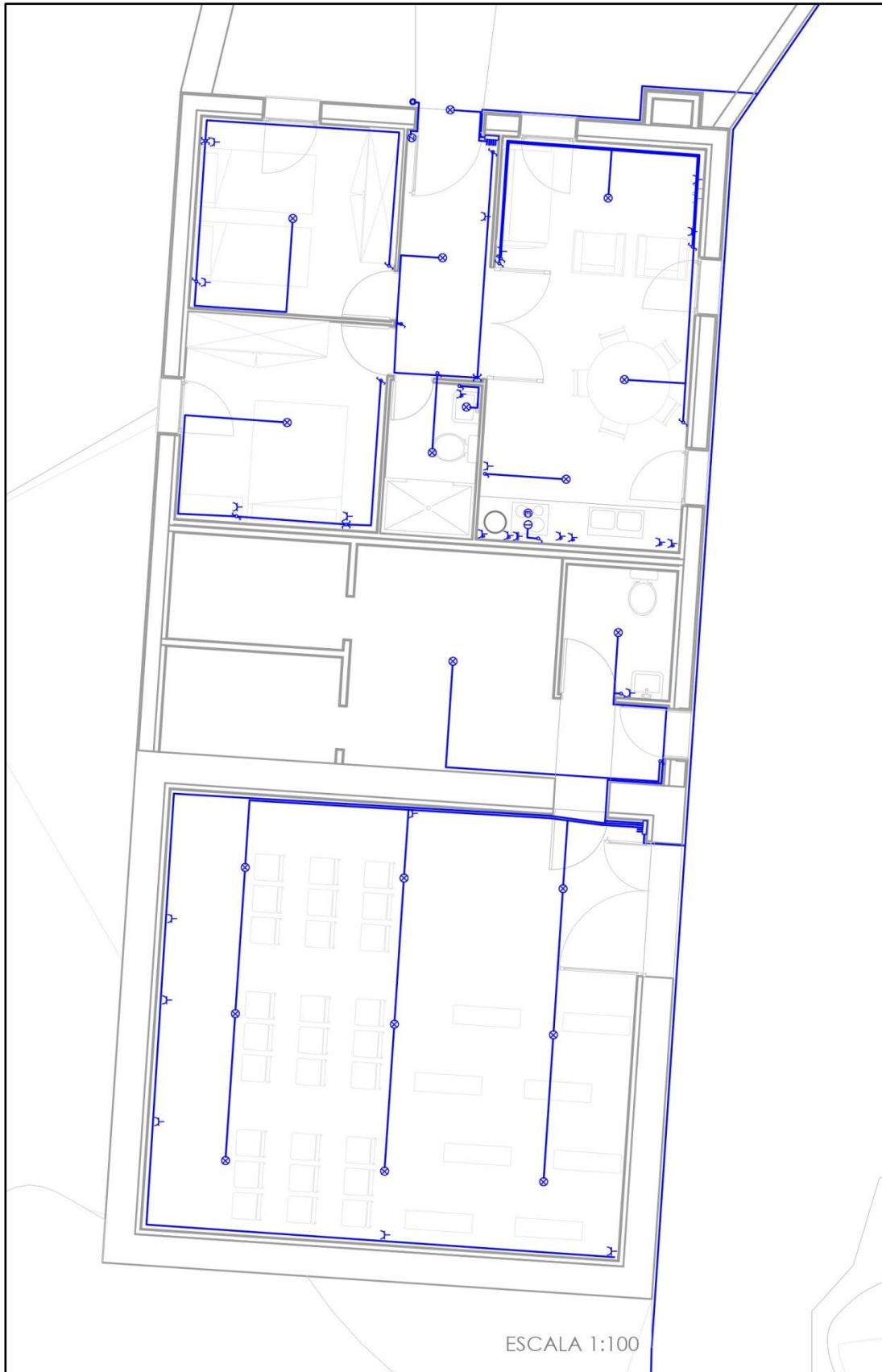
Plano de la instalación eléctrica de la vivienda del propietario y la sala de proyecciones
