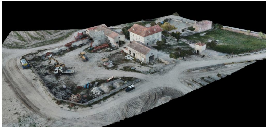
Ilustración 3 - Levantamiento 3D con nube de puntos.
