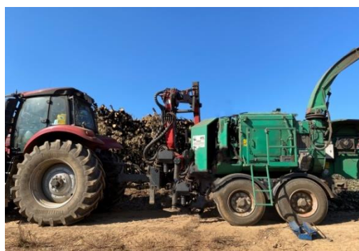
Fig 3.4. Astilladora Jenz con grúa y tractor. Fuente: Elaboración propia.
