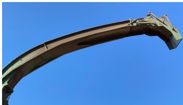
Fig.3.21: Chimenea de descarga. Fuente: Elaboración propia.
