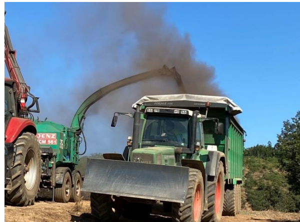
Fig.2.10: Astilladora descargando. Fuente: Elaboración propia.
