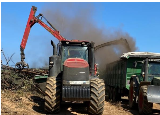
Fig.2.7: Astilladora trabajando y descargando en remolque. Fuente: Elaboración propia.
