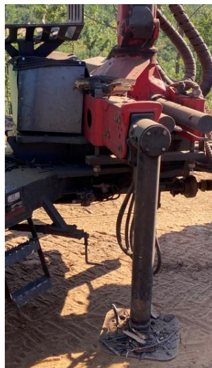
Fig.3.10: Gato estabilizador Fuente: Elaboración propia.
