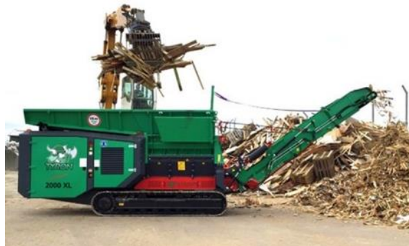
Fig.2.12: Pretrituradora HAAS TYRON Fuente: Cervisimag
