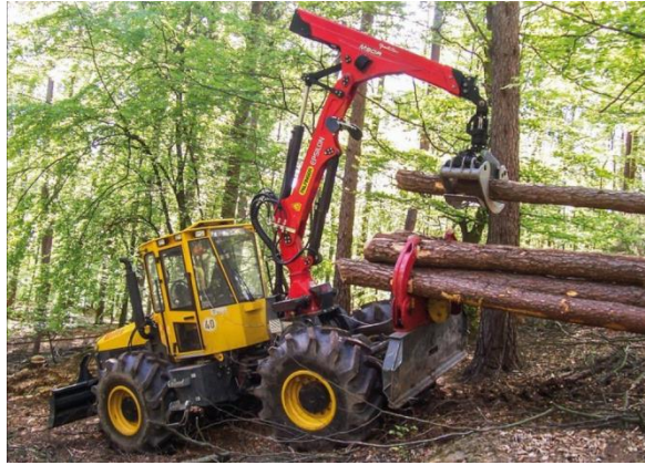
Fig.4.10: Grúa en un Skidder. Fuente: Palfinger.
