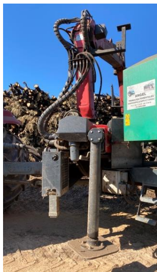
Fig.3.9: Gato estabilizador Fuente: Elaboración propia.
