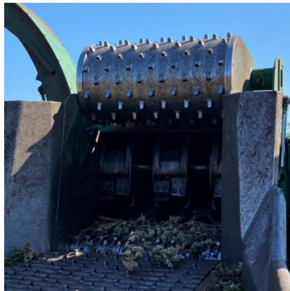
Fig.3.17: Cilindro abierto, en su interior el tambor rotativo. Fuente: Elaboración propia.
