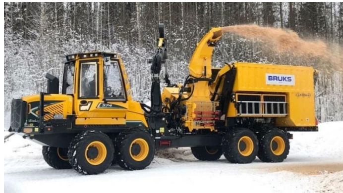
Fig.3.8 Astilladora independiente con camión y grúa incorporado. Fuente: LogMax
