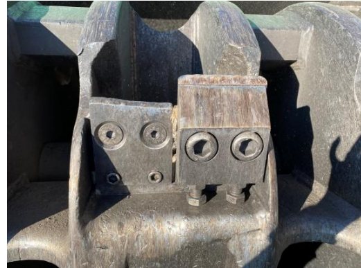
Fig.3.16: Cuchillas del tambor. Fuente: Elaboración propia.
