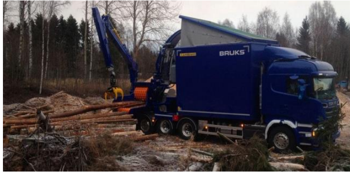
Fig3.7: Astilladora en camión con contenedor. Fuente: LogMax
