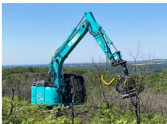
Fig.2.1: Procesadora forestal, con cabezal acumulador. Fuente: Elaboración propia.
