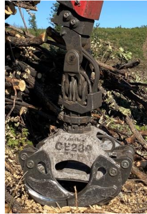
Fig.3.12: Grapa de la grúa. Fuente: Elaboración propia.
