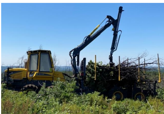
Fig.2.4: Autocargador cargando materia en la plataforma. Fuente: Elaboración propia.
