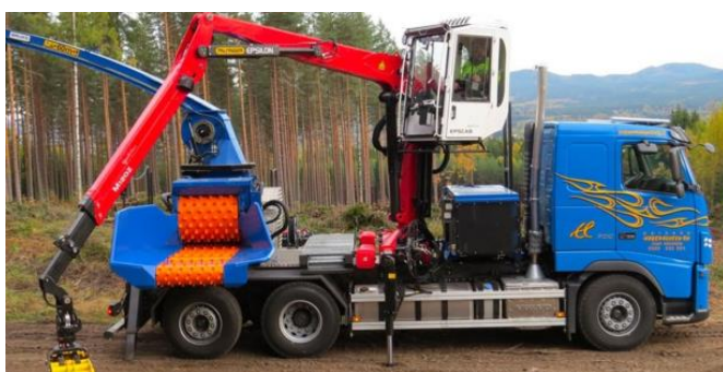
Fig3.5: Astilladora móvil en camión. Fuente: Log Max
