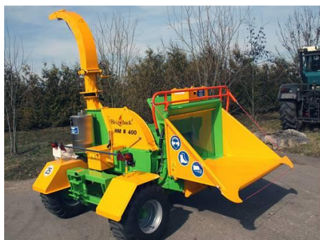
Fig 3.1: Astilladora forestal móvil carga manual. Fuente: interempresas
