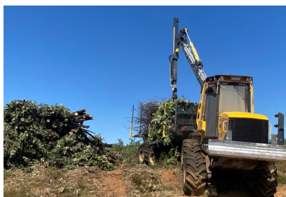
Fig.2.5: Autocargador descargando la materia en una pila. Fuente: Elaboración propia.
