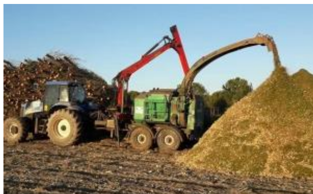
Fig.2.8: Astilladora trabajando y descargando. Fuente: Elaboración propia.
