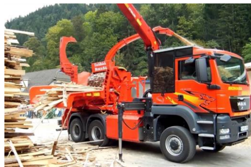
Fig3.6: Astilladora móvil en camión. Fuente: agroforestal ediciones
