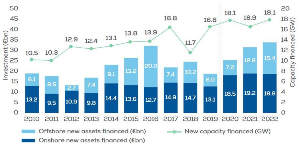
Figura 2.2 Evolución y previsiones de potencia instalada y millardos de inversión hasta 2022, para parques eólicos onshore y offshore (WindEurope, 2020)
