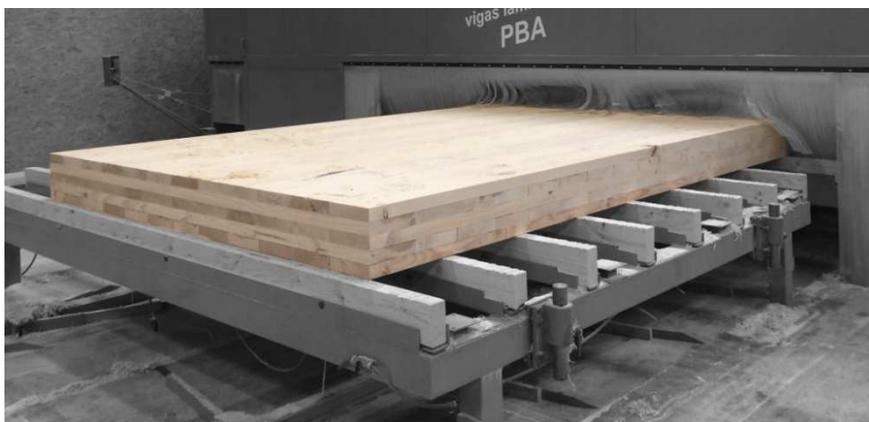
Fig. 51 Panel CLT en fábrica.
