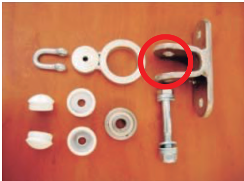
Figura 5.25: Detalle de los elementos de unión del rodamiento con los eslabones de la cadena. Agasa S.L.
