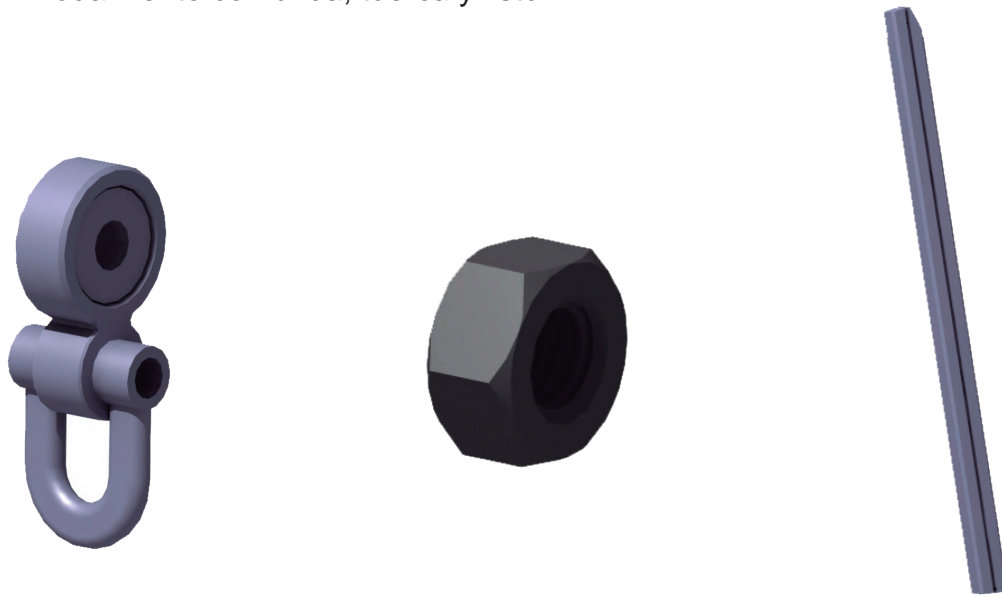
Figuras 5.60, 5.61 y 5.62: Vistas del rodamiento con brida, tuerca y listón de madera en perspectiva
