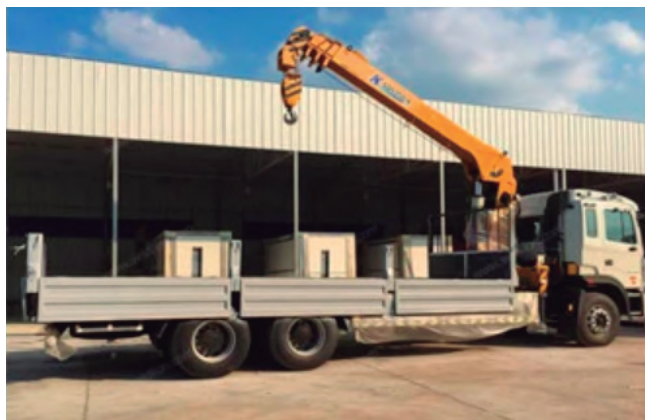
Figura 5.114: Camión grúa autocargante en con la grúa articulada Veldlion S.L.
