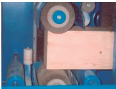
Figura 5.47: Proceso de cepillado del listón.
