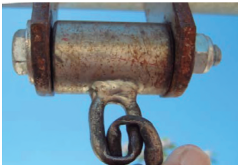
Figura 5.9: Degradación por fricción de eslabones. Agasa S.L.
