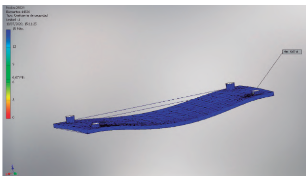
Figuras 6.7 y 6.8: Coeficiente de seguridad y desplazamiento
