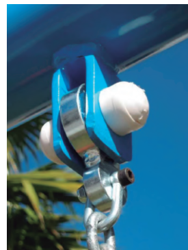
Figura 5.26: Detalle de los elementos de unión de la viga y las cadenas. Agasa S.L.
