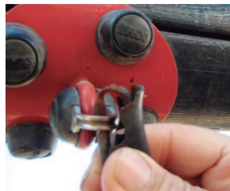
Figura 5.10: Degradación por fricción de eslabones. Agasa S.L.
