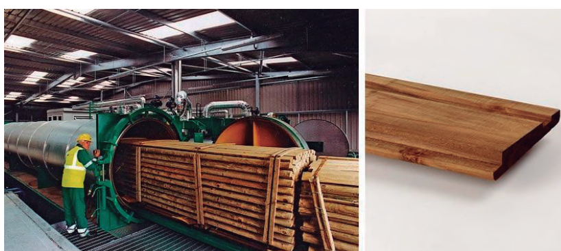
Figura 5.48: Recipiente hermético autoclave y madera tratada. [ https://maderame.com/tratamiento-autoclave/ ]
