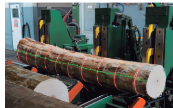
Figura 5.46: Calibración y rectificación por láser del tronco [ https://www.edu.xunta.gal/centros/cafi/aulavirtual2/mod/page/view.php?id=25062 ]
