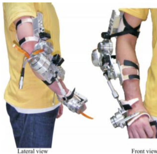
Figura 7: Exoesqueleto WOTAS. Fuente: Rocon et al., 2007.
