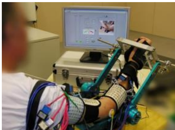
Figura 4: Detección de intención de movimiento y fatiga muscular a través de HD-EMG con un exoesqueleto. Fuente: Jordanic et al., 2016.
