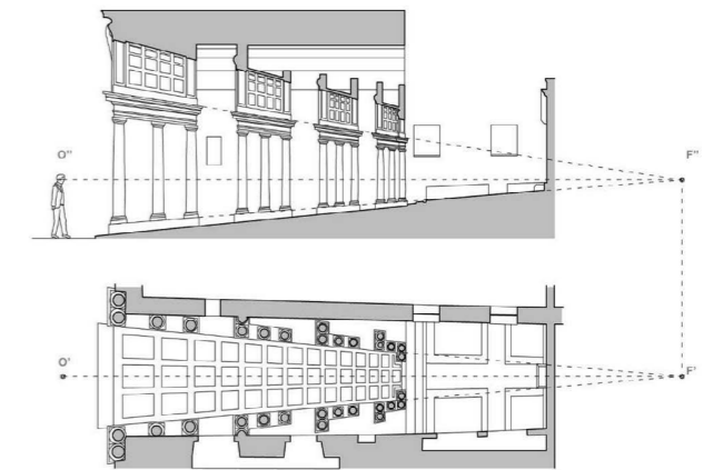
Fig. 5: Trampantojo sobre la Galería Spada en Roma, por Francesco Borromini (planta y sección)
