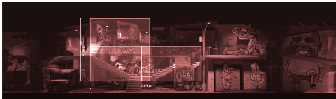
Fig 31: Disposición de tres proyectores sobre una fachada con forma irregular (proyecto a cargo de la empresa Lumitrix)
