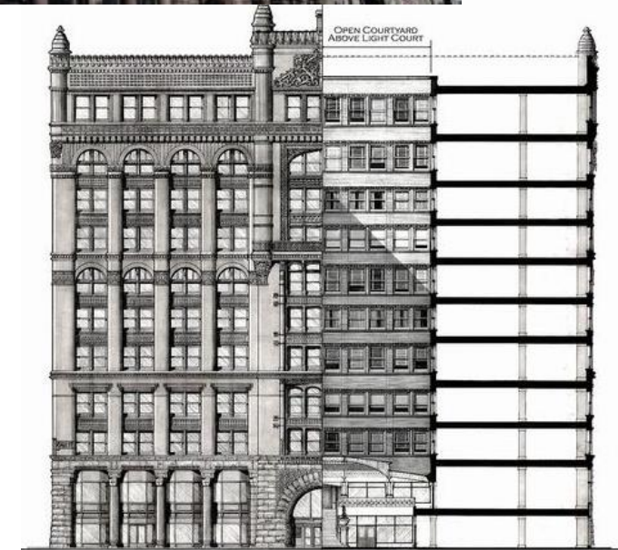
Figura 45. Alzado, sección The Rookery Building
