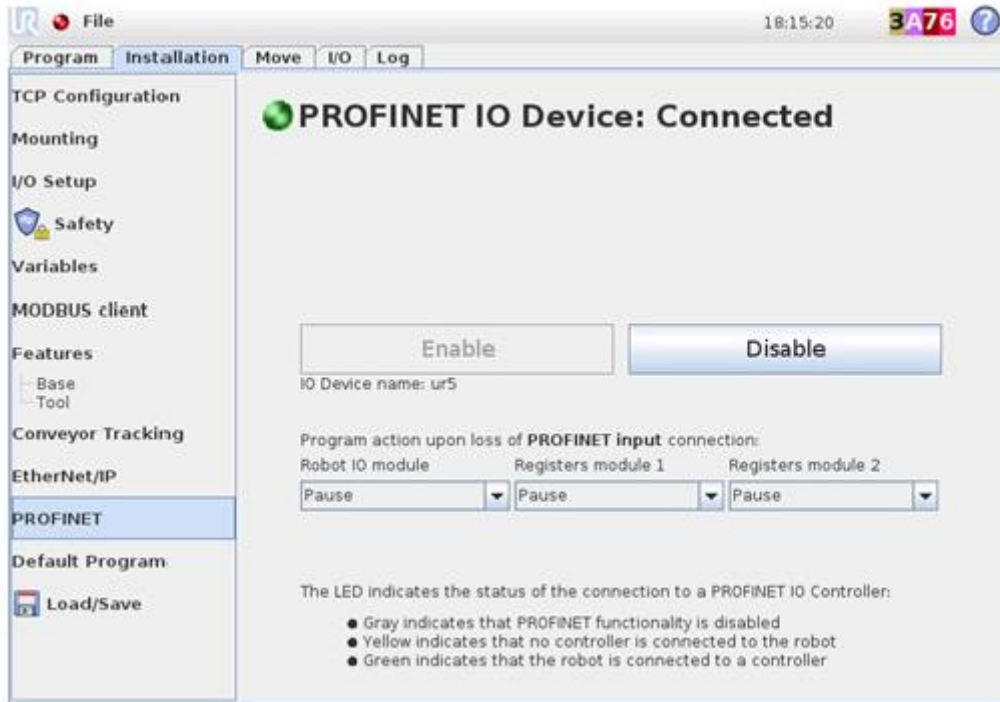
Figura 75: PROFINET habilitado y activo
