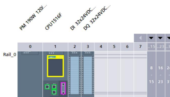
Figura 106: Sistema de control principal
