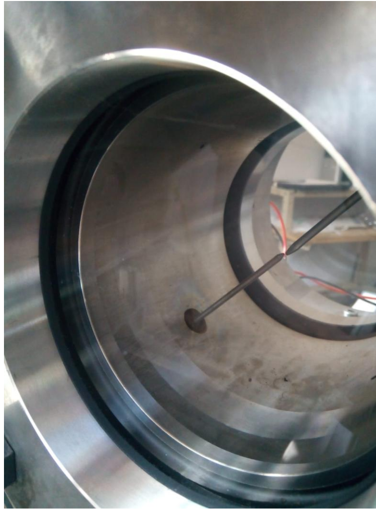
Figura 6. Fotografía del sistema de sellado de la bomba de combustión antigua. Tomada en el laboratorio de Máquinas y Motores Térmicos
