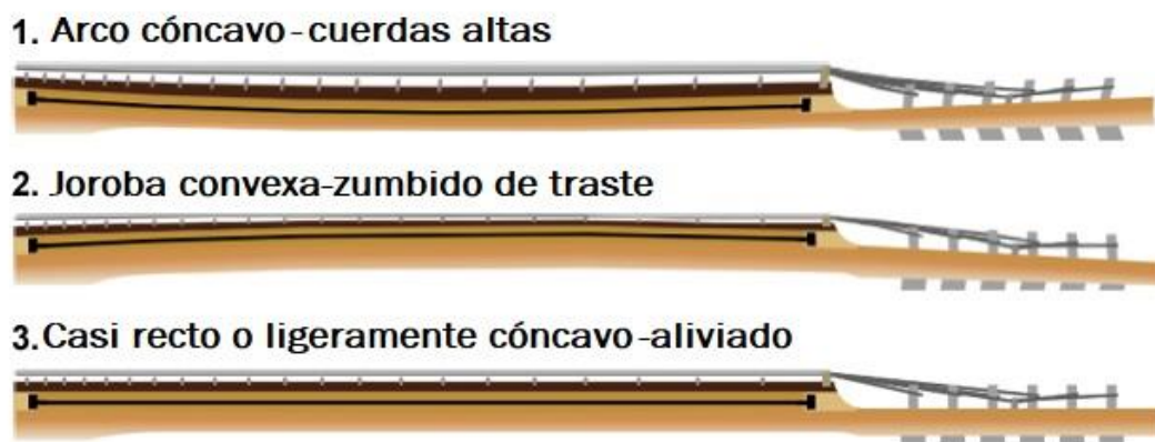
Figura 5. Efecto del alma o Truss Rod
