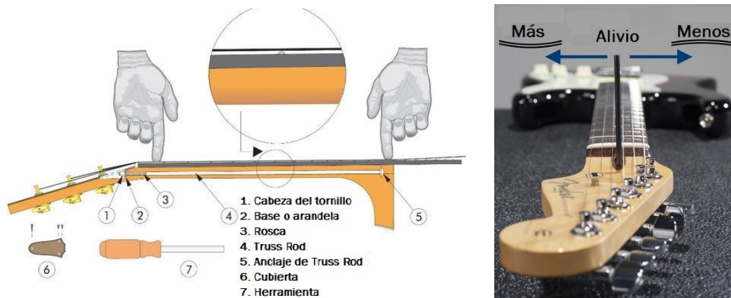
Figura 6. Corrección de arco de mástil con Truss Rod
