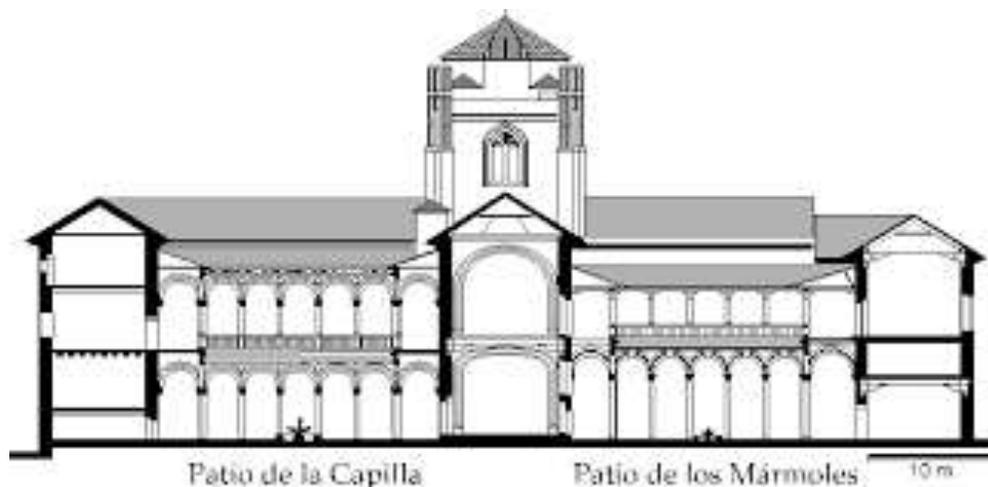
Imagen 55: Sección Hospital Real de Granada, GARCÍA CASCO.A, “Estado de conservación y proyecto de restauración de las columnas del patio de la capilla del hospital real de granada”
