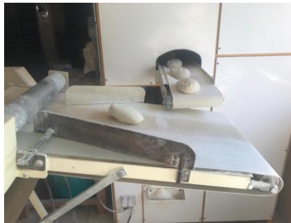
Ilustración 29. Almacenadora depositando bolas de masa sobre la máquina de barras
