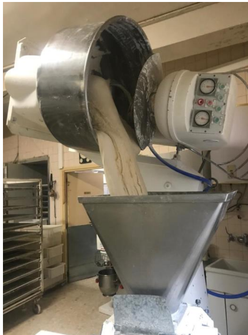
Ilustración 24. Amasadora volcando la masa
