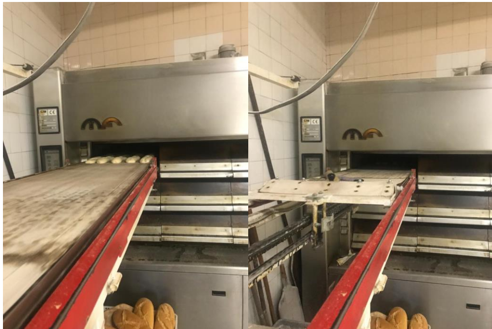
Ilustración 42. Cinta colocando barras en el horno principal
