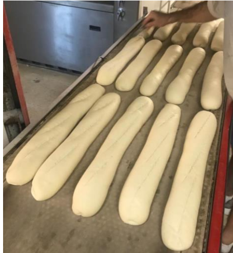
Ilustración 41. Barras en la cinta siendo marcadas
