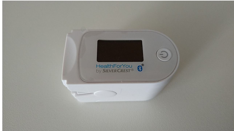
Ilustración 45. Modelo del oxímetro comercial empleado para realizar la calibración de nuestro dispositivo.
