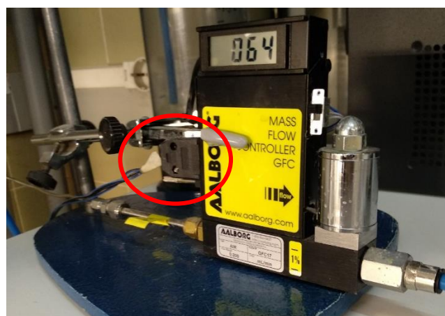
Figura 34: Controlador de flujo másico con la conexión RS232
