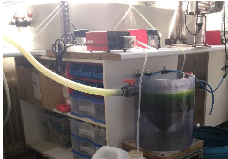
Figura 8: Sedimentador conectado al HRAP
