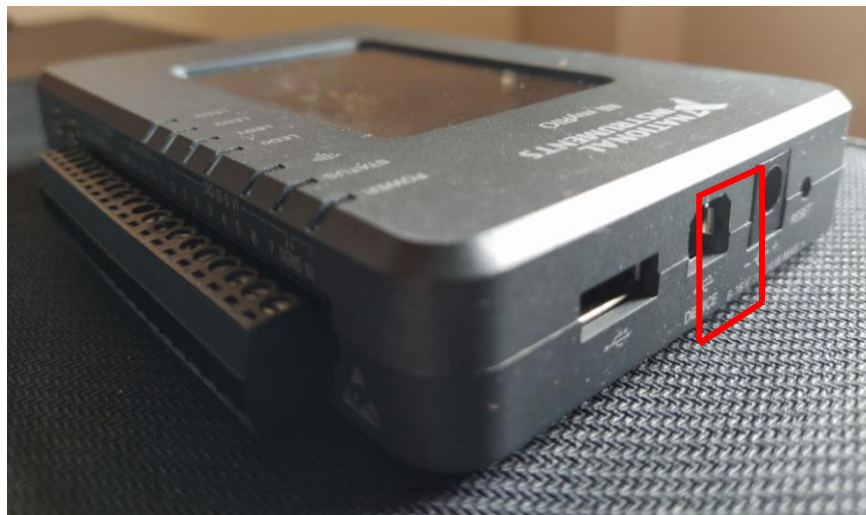
Figura 39: Puerto USB Device del controlador de planta
