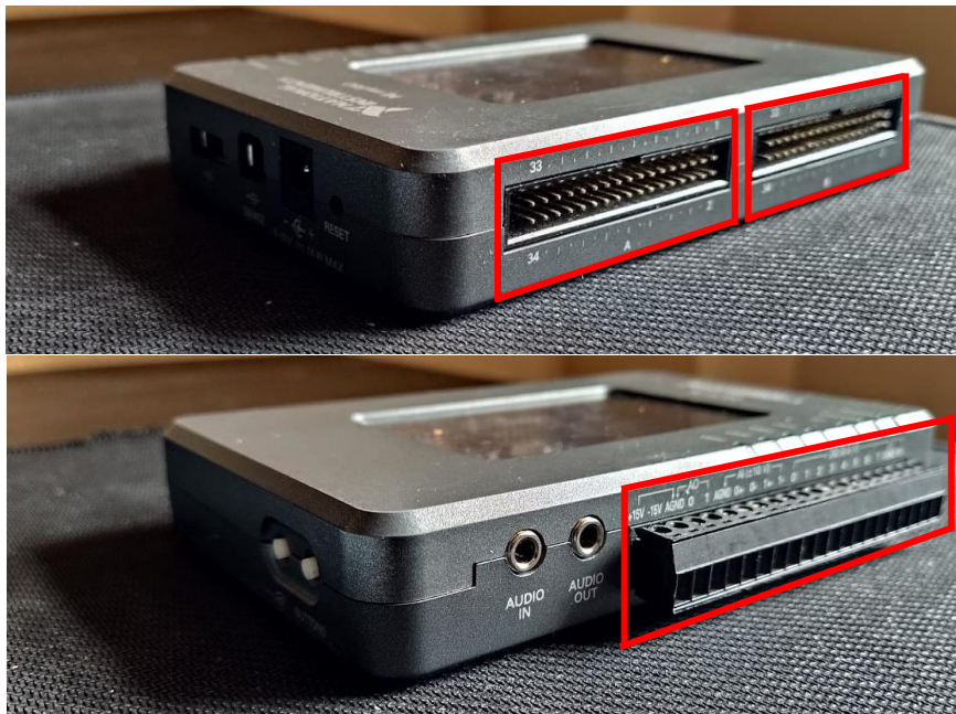
Figura 35: Pines de conexión: Superior A y B; Inferior C
