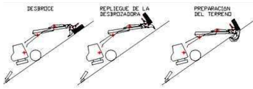
Figura 22: Secuencia del trabajo de la retroaraña con cabezal desbrozador-ahoyador. (Valledor.com)
