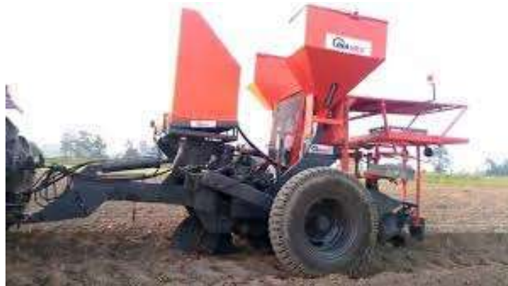
Figura 25: Plantadora forestal mecanizada (Equiforest.com)
