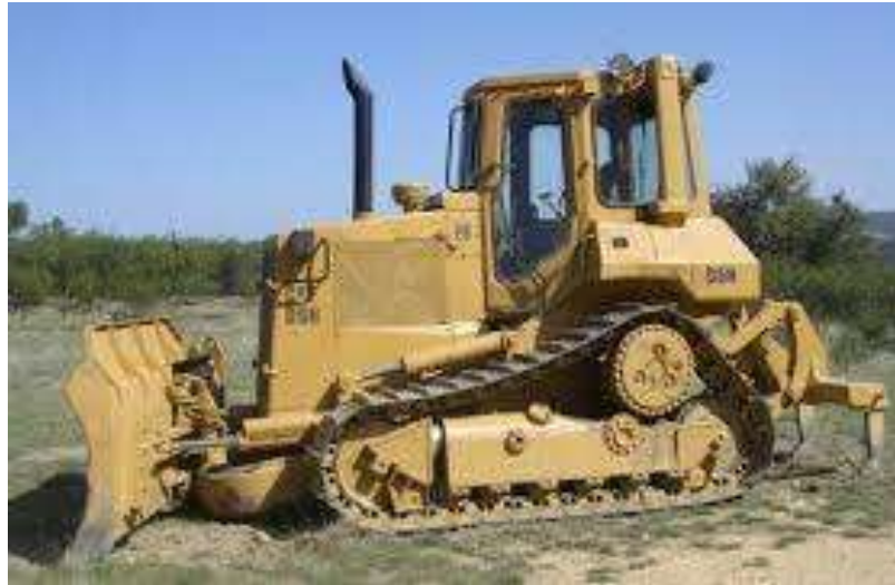
Figura 20: Tractor oruga con cuchilla y riper ( http://www.foesna.org )
