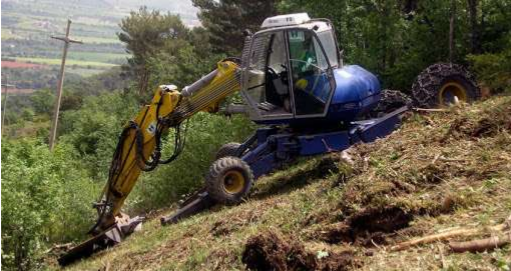
Figura 21: Retroaraña desbrozando (Coterram.com)
