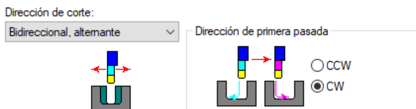
Ilustración 92. Direcciones de corte principal y de acabado en ranura interior
