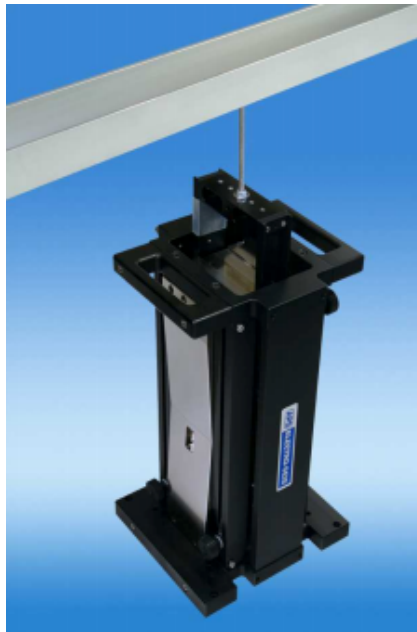
Figura 2.17. Shaker en modo cuerpo fijo
