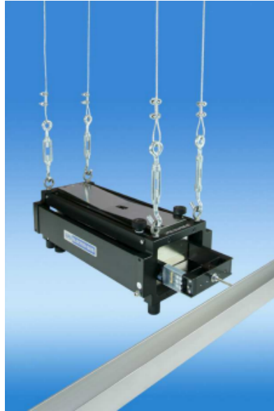
Figura 2.18. Shaker en modo del cuerpo libre
