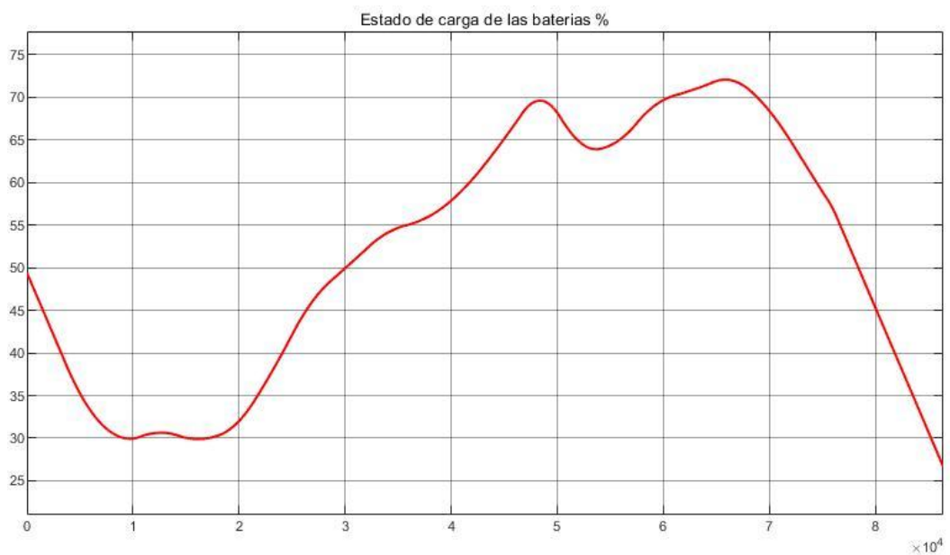
Figura 6.5 SOC baterías modo optimización de la energía
