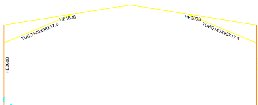
Figura 69. Elementos del tercer pórtico dimensionados individualmente.
