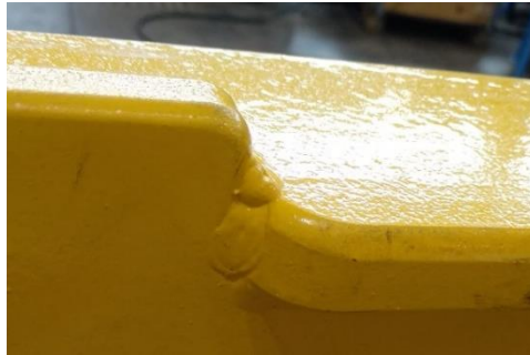
Figura 4-35 Detalle aristas redondeadas. (Fuente propia).
