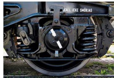
Figura 2-10 Caja de grasa: posicionamiento.
