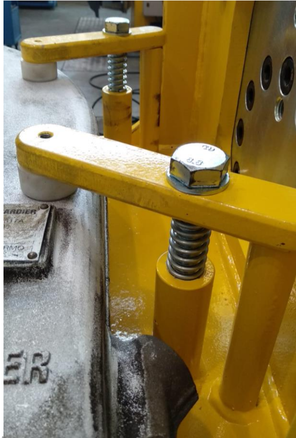
Figura 4-37 Detalle sujeción reductor superior en inferior, con reductor acoplado. (Fuente propia).
