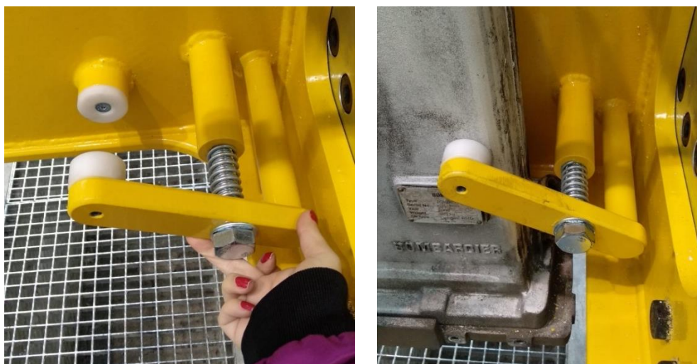
Figura 4-36 Detalle sujeción reductor y apoyo. Sin reductor (izda.) y con él (dcha.). (Fuente propia).
