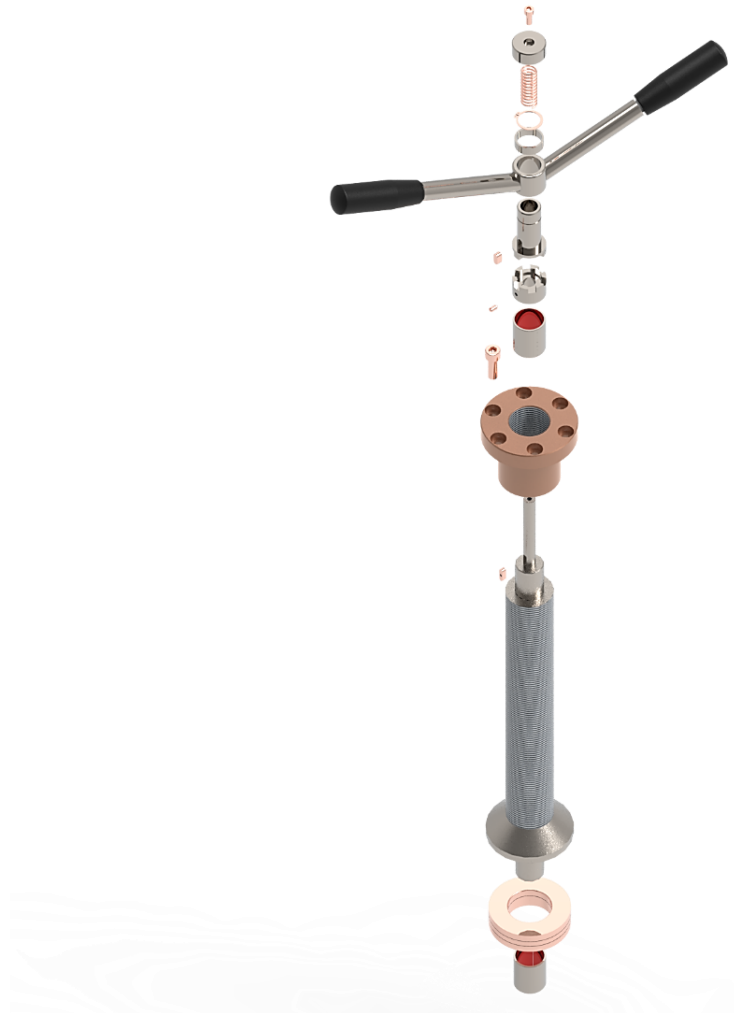
Figura 5-25 Mecanismo de desplazamiento vertical explosionado. (Fuente propia).
