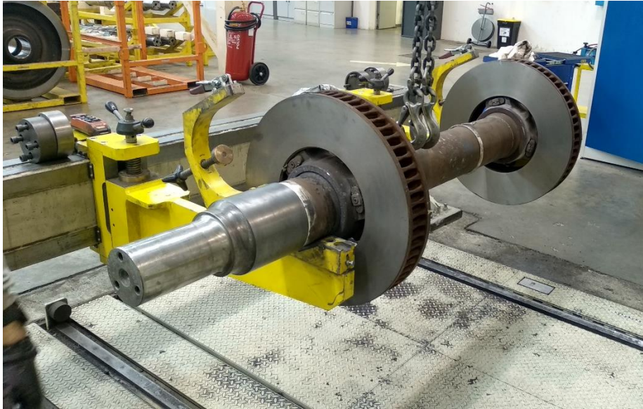
Figura 5-1 Prefitting modelo de partida, con eje provisto de dos discos de freno. (Fuente propia).
