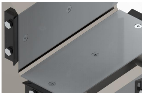
Figura 5-29 Detalle tornillos de cabeza hexagonal avellanada y tornillos de cabeza hexagonal. (Fuente propia).
