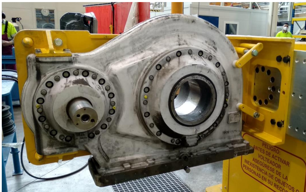
Figura 4-38 Conjunto completo con reductor acoplado, parte delantera. (Fuente propia).
