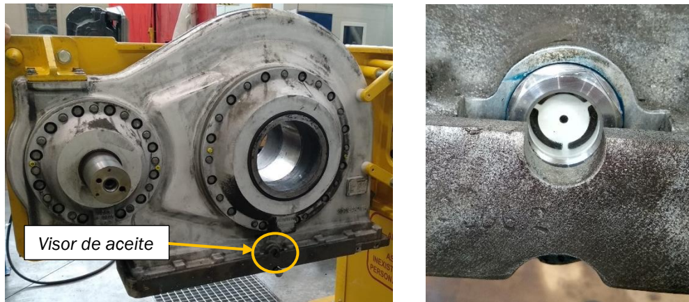
Figura 3-2 Visor de aceite instalado en el cárter del reductor (izda.) y en detalle (dcha.). (Fuente propia).
