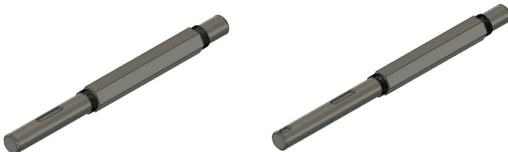
Figura 38: Eje conducido y eje motriz. Elaboración propia.
