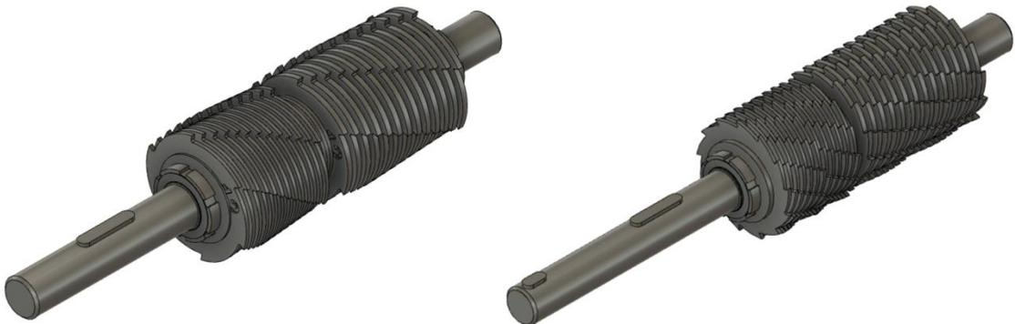
Figura 46: Ejes con las cuchillas montadas. Elaboración propia
