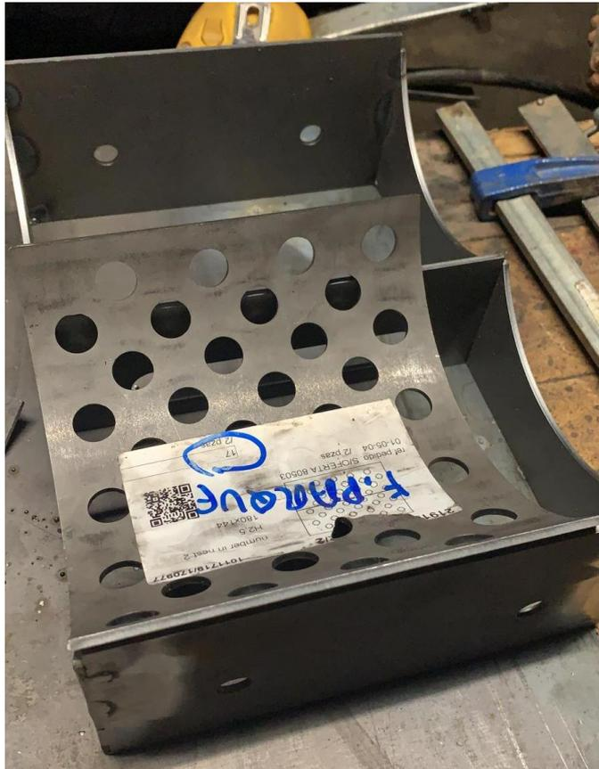
Figura 138: Rejilla plegada por el eje erróneo. Elaboración propia.
