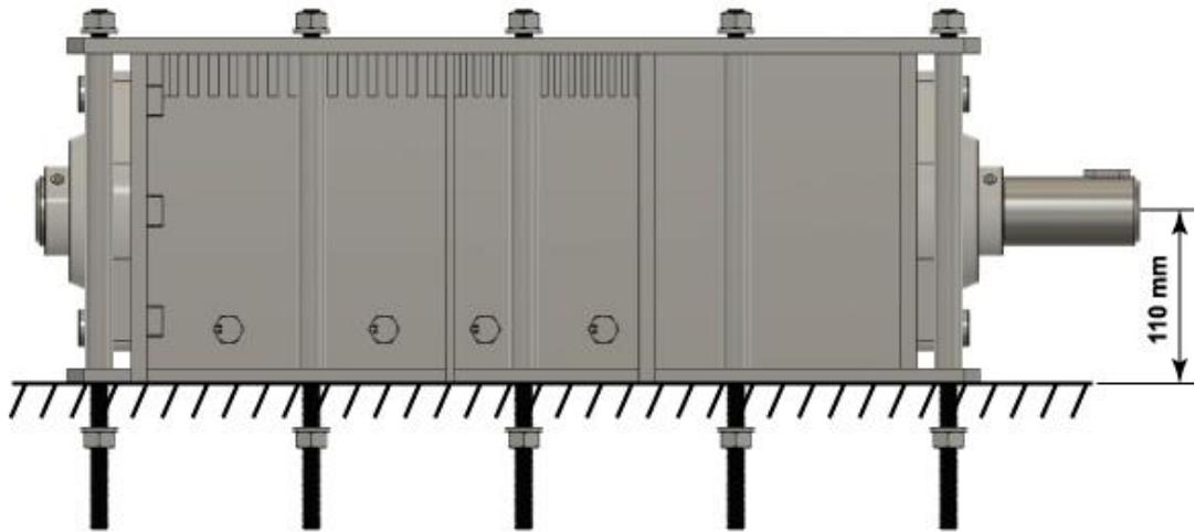
Figura 98: Altura de la entrada de Spiker respecto a la bancada. Elaboración propia.
