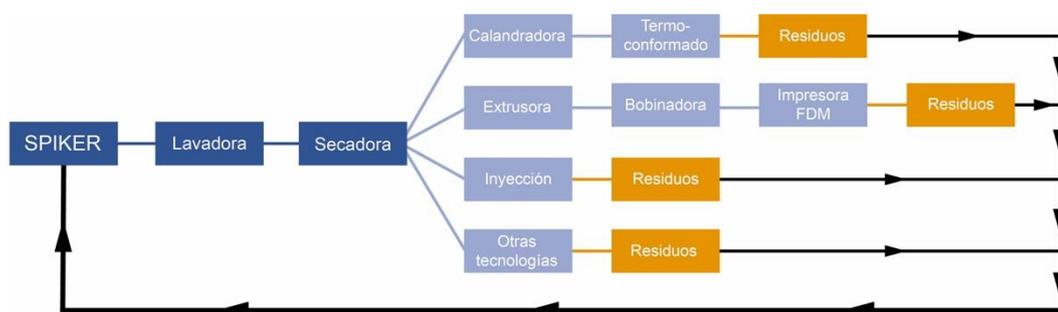
Figura 2: Diagrama de flujo para el reciclado de plásticos. Elaboración propia.
