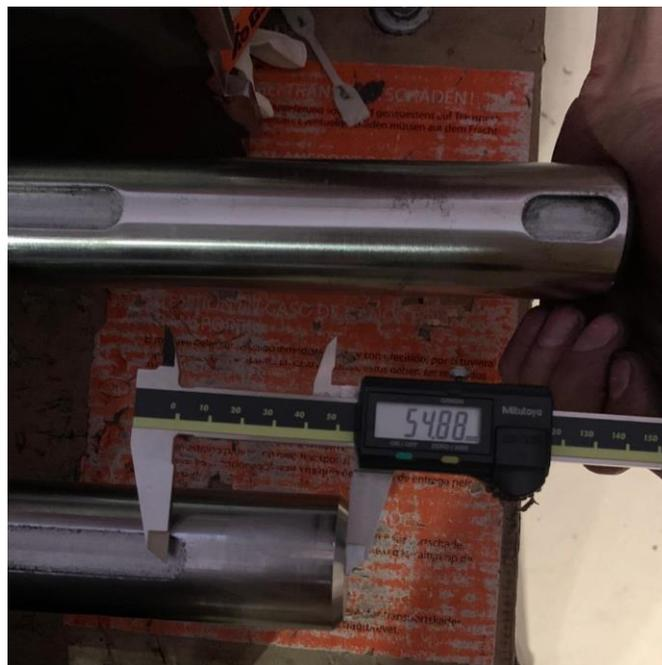
Figura 136: Error de mecanizado del eje. Elaboración propia.
