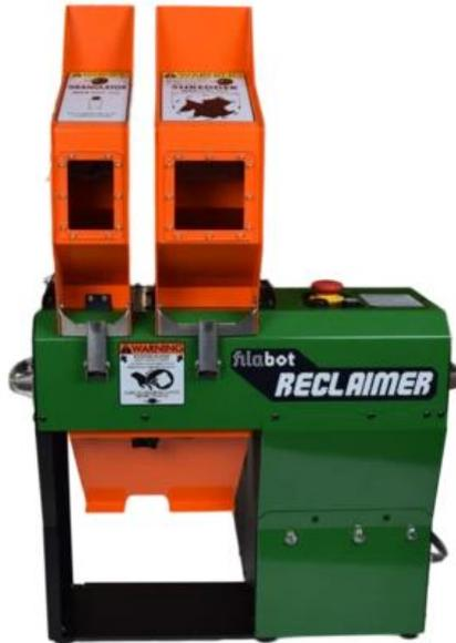
Figura 18: Trituradora de Filabot. [22]
