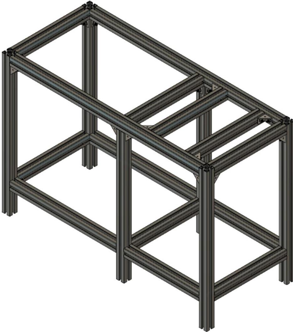
Figura 90: Esqueleto del bastidor con escuadras. Elaboración propia.
