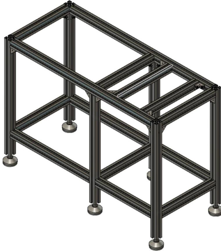
Figura 93: Esqueleto bastidor con pies. Elaboración propia.
