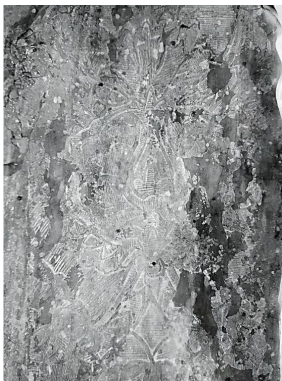
Examen mediante RX del respaldo del baldaquino: detalle de la policromía con brocado aplicado, contraste visible de la lámina de peltre y pigmentos pesados. Calco de la imagen de RX y reconstrucción de los motivos decorativos, tipo piñas, del brocado aplicado. Foto: Museu Frederic Marés © Carmen Sandalinas
