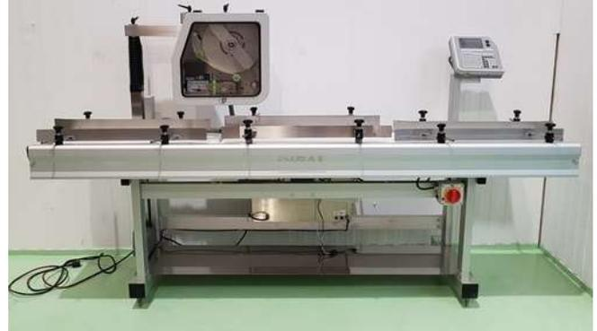
Figura 19 Etiqueta automática de pesaje
