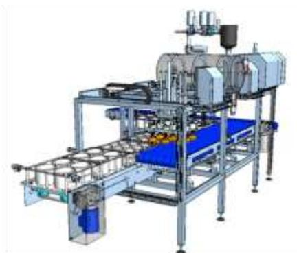
Figura 10 Desmoldeadora automática por vacío
