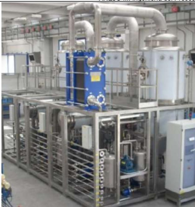
Figura 21 Evaporador de efecto múltiple
