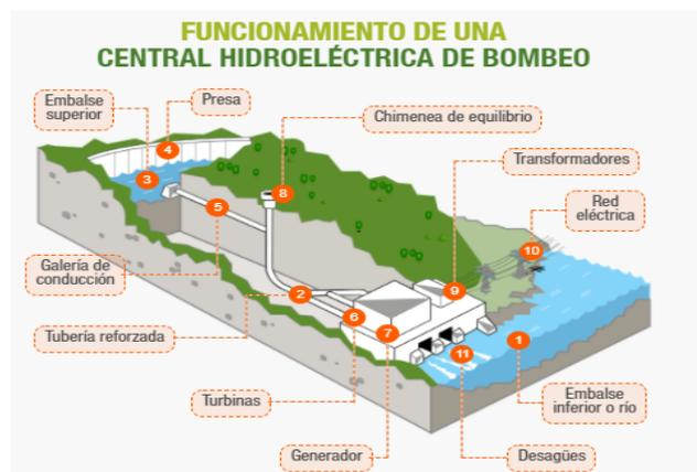
Figura 38. Partes de una Central de Bombeo [www.iberdrola.com/medio-ambiente/central-hidroelectrica-bombeo]
