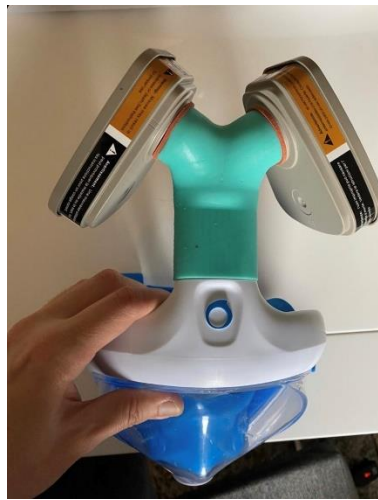
Ilustración 2.24: Máscara snorkel EasyBreath adaptada con filtros
