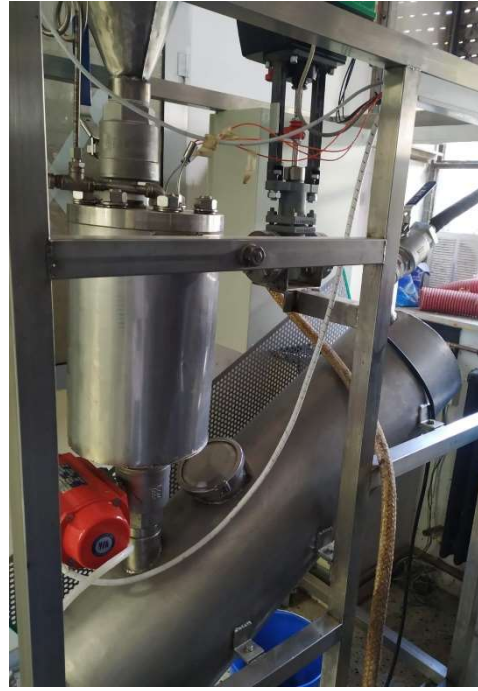
Ilustración 11. Reactor de hidrólisis y tanque flash
