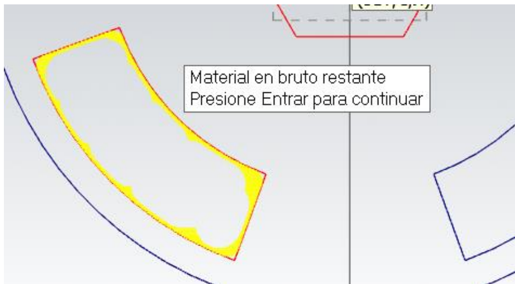
Figura 109 – Detalle Material en bruto restante. Mostrar material en bruto. Remecanizado. Caso práctico. Cajera.
