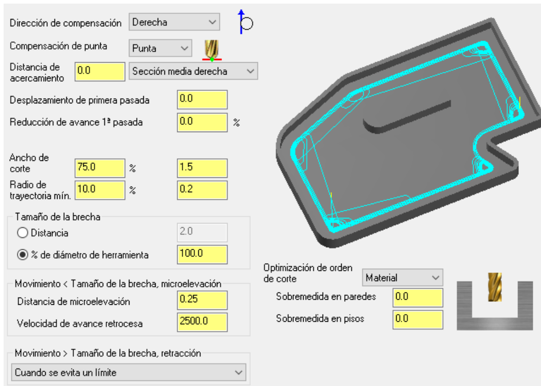
Figura 168 – Parámetros de corte. Caso práctico. Contorno dinámico 1.
