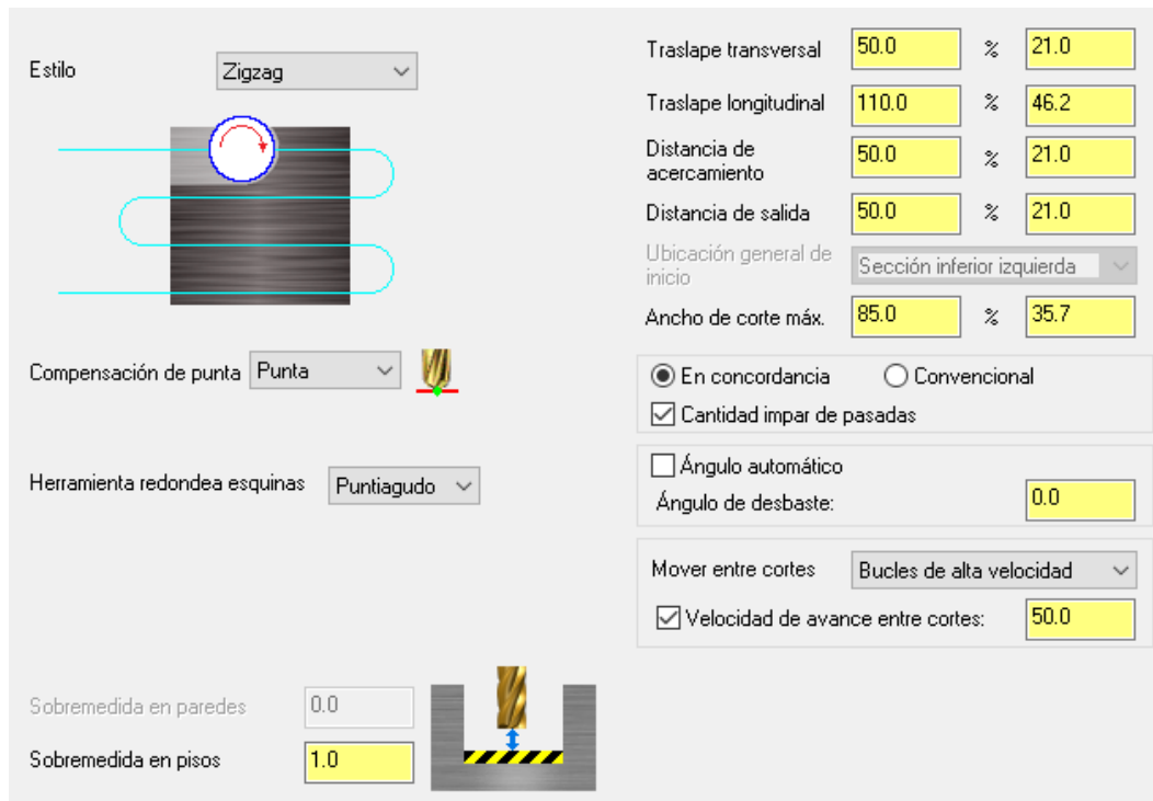
Figura 63 – Parámetros de corte. Planeado.
