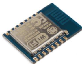
*Ilustración 18.- Módulo ESP12-E*
