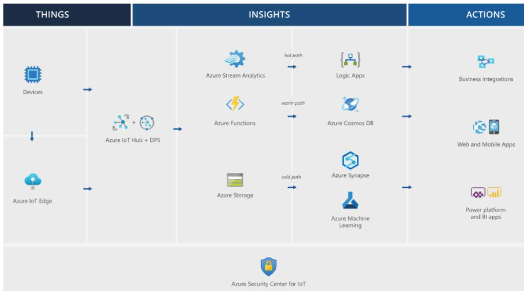
Ilustración 26.- Arquitectura de referencia de Azure IoT [19]
