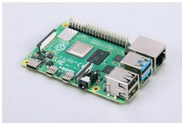
*Ilustración 7.- Raspberry Pi 4 modelo B*
