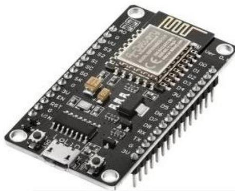
Ilustración 21.- NodeMCU V3.
