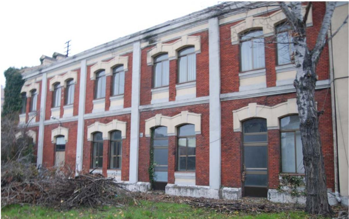
Edificio señalado en el plano con la letra “D”\_ Dormitorio de maquinistas. Manteniendo la misma estética de fábrica de ladrillo y zócalo y remates en piedra. Vemos los blancos capialzados de las ventanas con forma de arco muy tendido.
