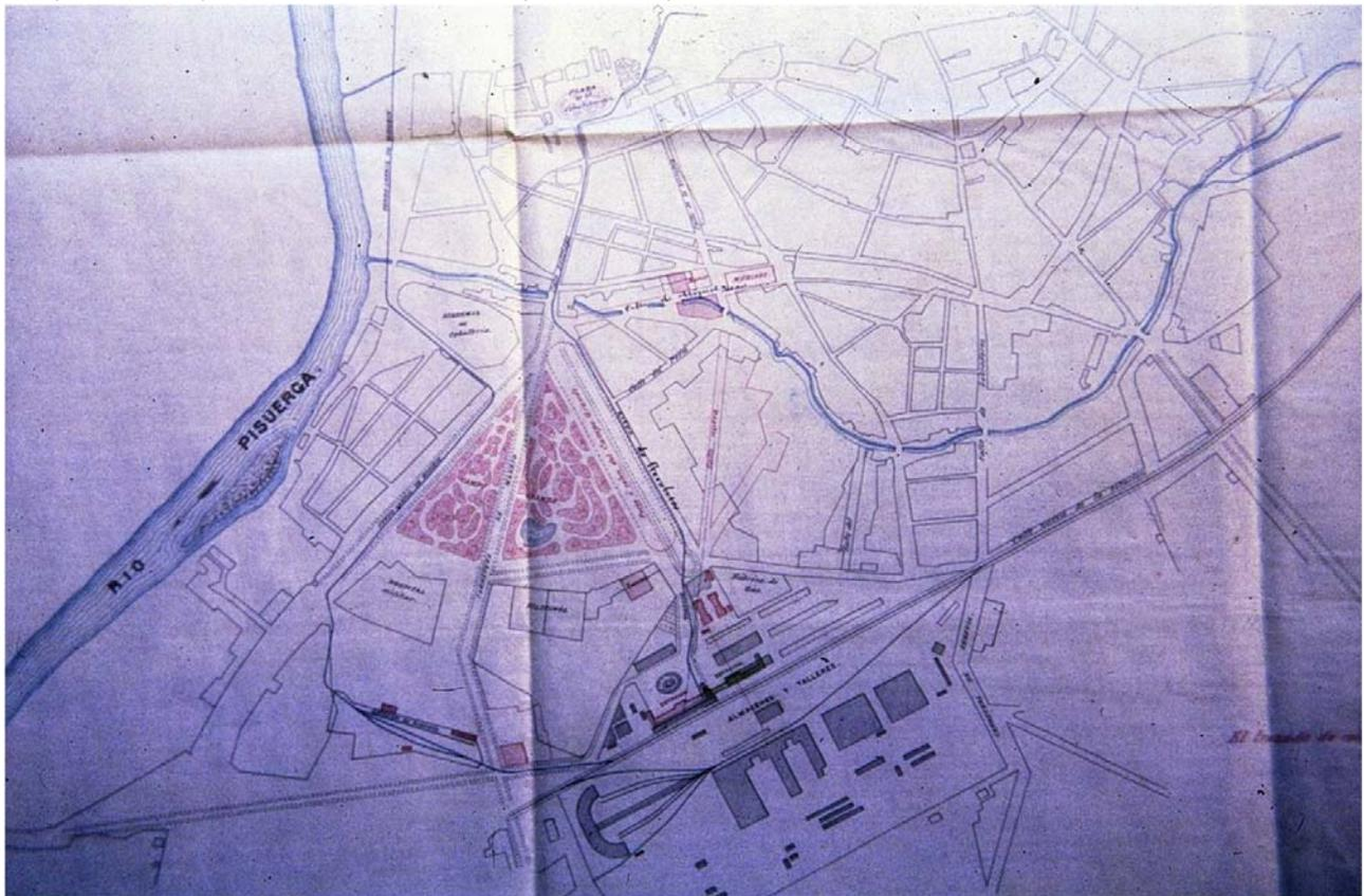
Plano de la Compañía de Caminos de Hierro del Norte de España. Se representa lo ya existente en gris rayado (Muelles, cocheras, edificio antiguo de viajeros en madera, depósito de locomotoras, talleres y almacén general), en rojo rayado lo nuevo planificado (tanteo posición del nuevo edificio de viajeros, economatos, estación La Esperanza, Calles Gamazo y Muro, Campo Grande, edificio SIC y C/ Miguel Íscar, mercado del Campillo, jardín de la Plaza Mayor).
