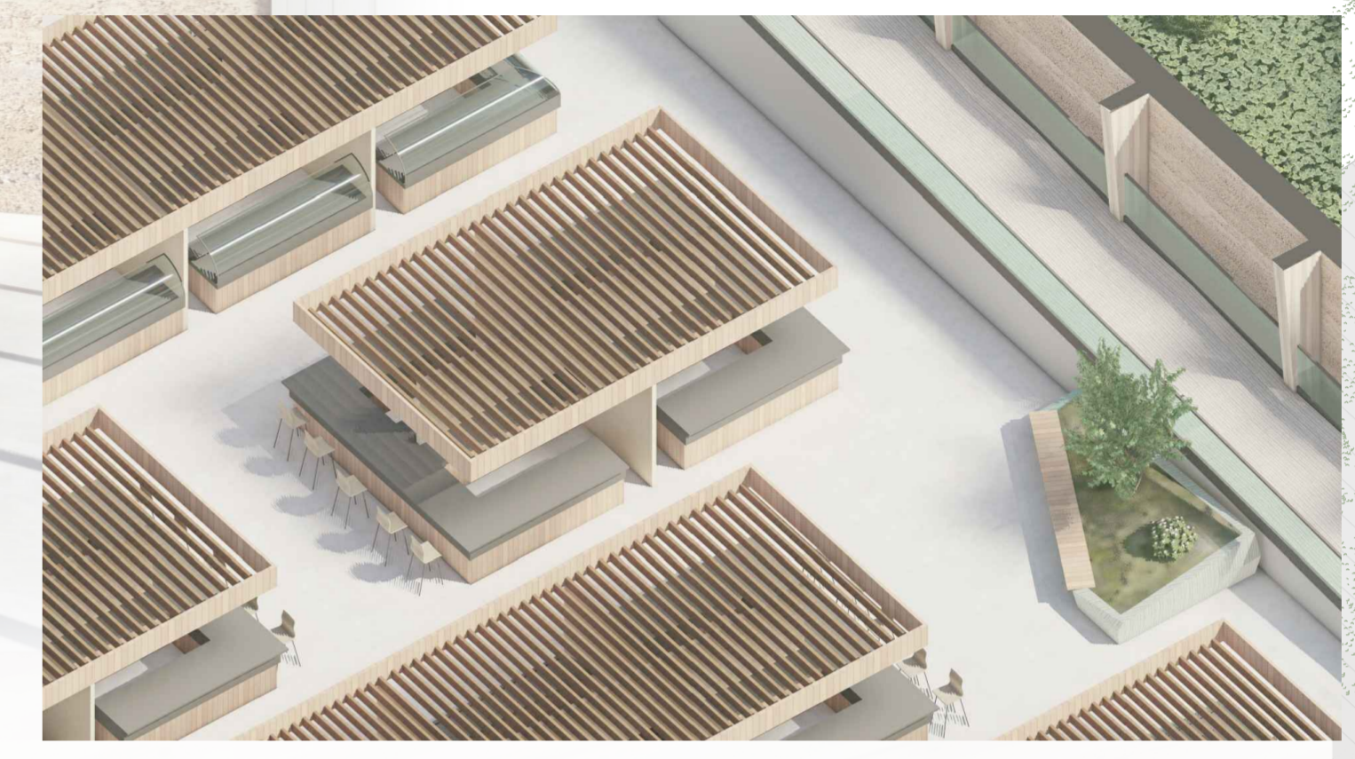
LA CUBIERTA DE LOS PUESTOS DE MERCADO, SE SOLUCIONA CON UN ENTRAMADO DE MADERA, QUE TAMIZA LA LUZ Y PROPORCIONA SOPORTE DE ELEMENTOS DEL PUESTO
