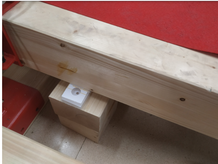
Figura 80: Preparación de la plataforma para realizar la comparación en el dominio temporal, se bloquea el desplazamiento máximo que puede experimentar la estructura de forma que al subirse una persona encima se llega a este tope fijado. Al saltar esta persona de la plataforma la fuerza de reacción ejercida será siempre la misma, haciendo el ensayo repetible.
