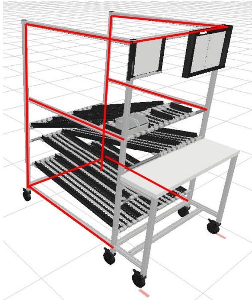
Figura 5.24 Armazón principal de la mochila del puesto de reciclado.
