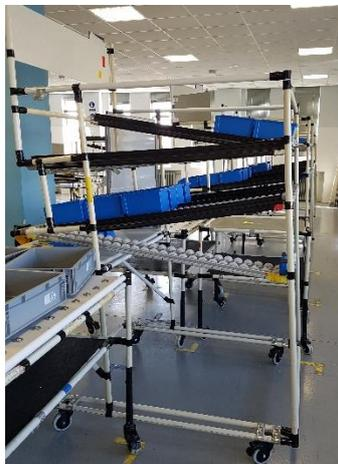
Figura 4.4 Armazón del Puesto de Montaje.
