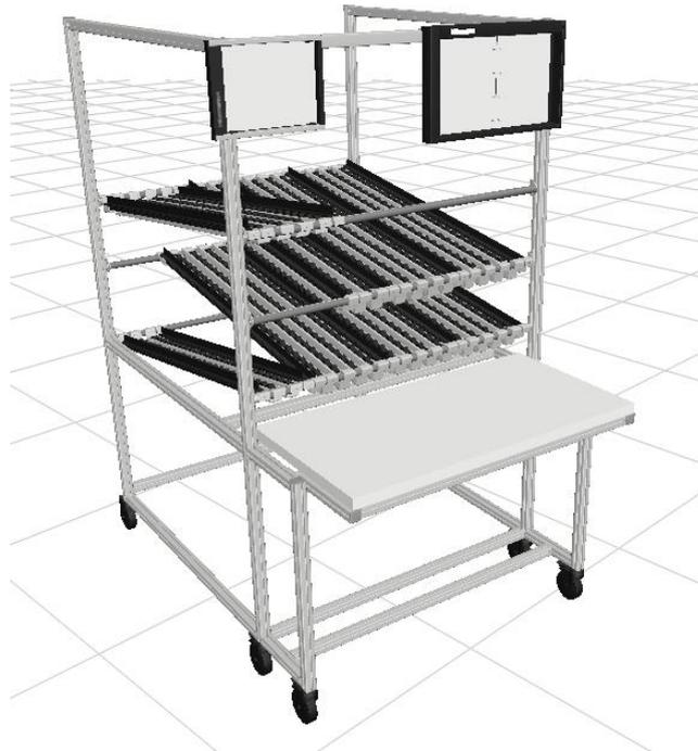
Figura 5.21. Diseño final del puesto de montaje.
