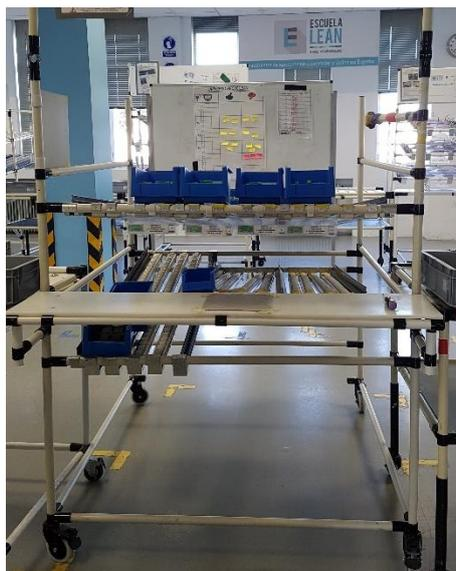
Figura 4.10. Armazón Puesto de Reciclado.
