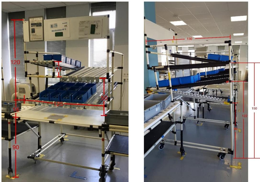
Figura 5.1. Medidas Puesto de Montaje actual.
