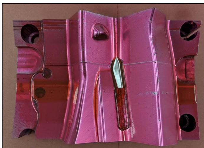
Figura 66. Aplicación del penetrante
