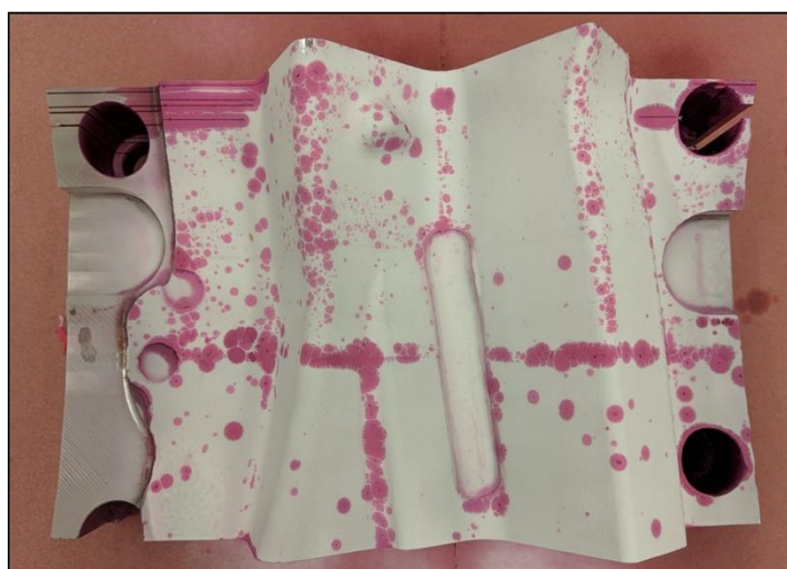
Figura 67. Aplicación del revelador e inspección de la pieza
