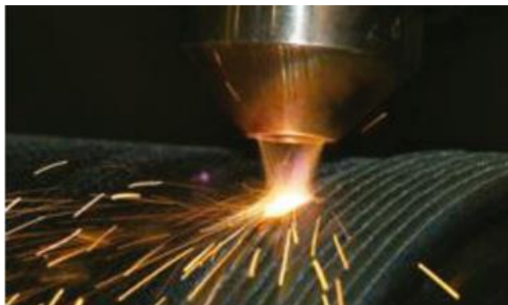
Figura 4. Proceso de laser cladding (Fuente: [2])
