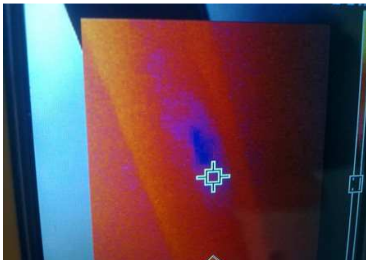
Figura 7. Termografía en madera para control de plagas
