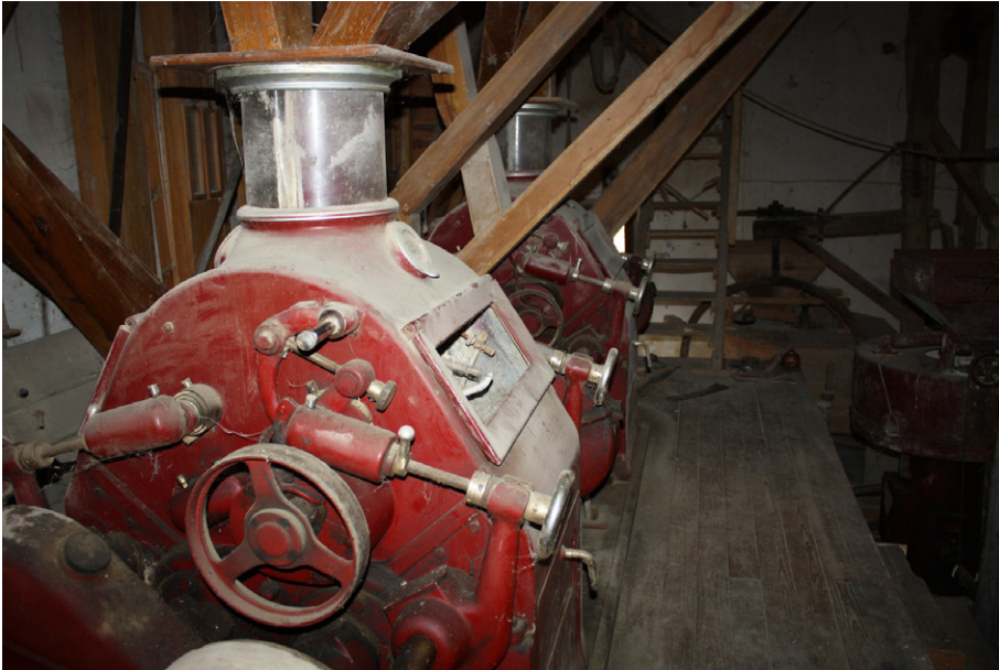
Interior del Molino de Arriba de Gradefes (León), con sistema de cilindros en primer término y por piedras al fondo. Foto: Susana Barbeito Pérez.
